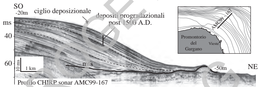
Fig. 34 – Geometria progradazionale dei depositi di HST a NE del Promontorio del Gargano e al tetto di un preesistente alto morfologico. Il topset del cliniforme si trova a meno di 30 m di profondità mentre il bottomset erosivo è a circa 50m.
