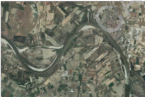
Fig. 20a - Variazioni nel corso del fiume Po tra il XIX ed il XXI secolo rappresentate nella cartografia ufficiale: tavolette del Foglio 173 Parma (IGM 1881 e 1935) e ortofoto (AIMA 1996). Si notano i cambiamenti della forma dei depositi in alveo e lungo le sponde.
