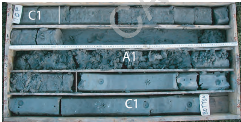
Fig. 11 - Argille di piana inondabile (C1) con intercalate sabbie di canale fluviale legate allo sviluppo dei sistemi appenninici (A1). Le sigle utilizzate sono riferite all'Appendice 1.
