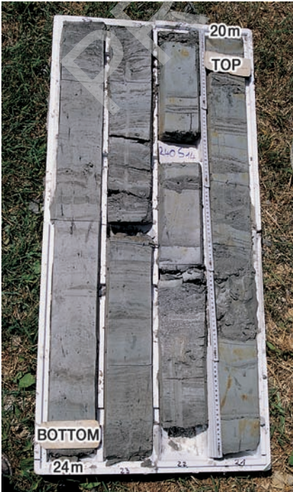
Fig. 19 - Sottili alternanze di argille, limi e sabbie fini che caratterizzano i depositi di tracimazione fluviale (facies A3 ed A4). Sondaggio 240-S14 (S. Leonardo, W di Forlì), intervallo 20-24 m.
