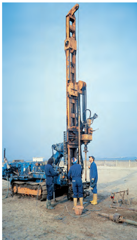
Fig. 6 - Sonda utilizzata per i sondaggi a carotaggio continuo di profondità inferiore a 70 m, realizzati per il progetto CARG. Nell'immagine la sonda sta eseguendo il sondaggio 256-S6 "Cesenatico" (ditta SOGEO Lugo, dicembre 1997).
