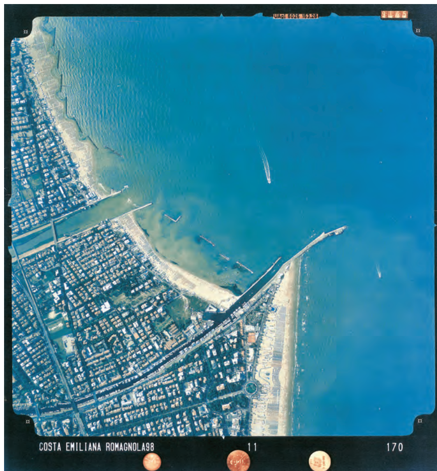
Fig. 25 - Immagine aerea del molo di Rimini. I ripetuti prolungamenti dei moli del porto di Rimini hanno bloccato il flusso delle sabbie litoranee, diretto da sud verso nord, creando una larga spiaggia a sud ed erosione a nord (autorizzazione alla divulgazione - concessione SMA n. 01 539 del 16/9/1998).
