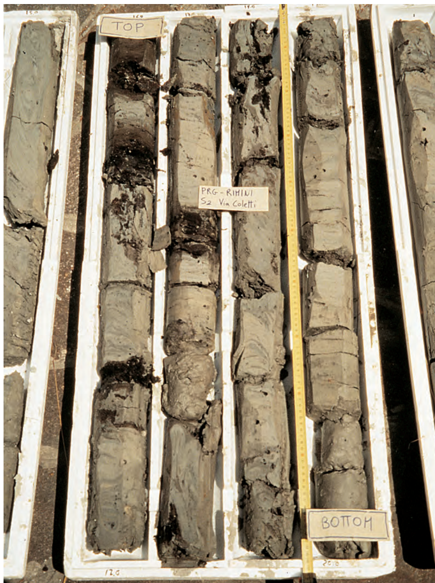
Fig. 15 - Carota del sondaggio 256110P505 (messo a disposizione dal Comune di Rimini) eseguito presso la città di Rimini (AES g intervallo 16-20 m, "sezione superficiale" A-A', Fig. 7). La foto mostra il notevole sviluppo di depositi argillosi organici scuri e di torbe di origine palustre alla base del Subsistema di Ravenna. Si noti anche la frequente presenza di porzioni di carota fortemente disturbate: la notevole plasticità di questi depositi rende spesso difficoltoso il recupero di carote integre in questo intervallo stratigrafico.
