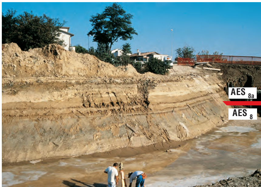
Fig. 16 - Fronte di scavo del Canale Emiliano-Romagnolo nel settore nord-occidentale del Foglio 256. La foto illustra il contatto dei depositi sabbioso-limosi giallastri di argine dell'unità di Modena (AES 8a ) al di sopra dei depositi limoso-argillosi più scuri (tracimazioni fluviali indifferenziate) del Subsistema di Ravenna (AES 8 ).
