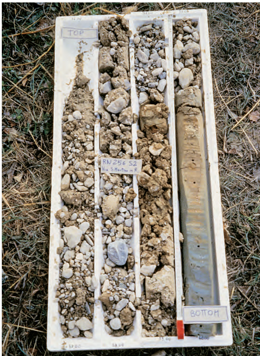
Fig. 21 - Carota del sondaggio 256-S2 (AES 7 , intervallo 36-40 m, "sezione superficiale" C-C'-C", Appendice 1) effettuato tra lo sbocco vallivo del F. Marecchia ed il litorale adriatico (Fig. 7). La foto mostra il contatto netto ed erosivo delle ghiaie di canale fluviale sui depositi fini di tracimazione fluviale sottostanti. In questo carotaggio il contatto rappresenta l'appoggio del lobo di conoide regressivo del Subsistema di Villa Verucchio sui depositi di piana alluvionale.
