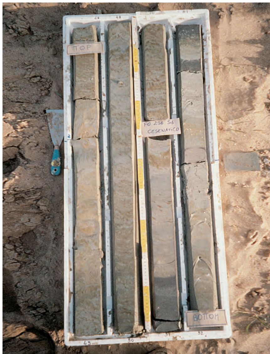
Fig. 22 - Carota del sondaggio 256-S6 (AES 7 , intervallo 48-52 m, “sezione superficiale” D-D’, Appendice 1) effettuato nel litorale adriatico del quadrante di NW del foglio, presso Cesenatico (Fig. 7). La foto mostra una tipica associazione di facies di piana alluvionale della bassa pianura in cui ai depositi argillosi e limosi caratterizzati dalla presenza di screziature giallastre, si alternano argille scure organiche. Questa associazione riflette l’alternanza, in questo contesto ambientale, di condizioni di piana drenata (con abbassamento della falda ed ossidazione dei depositi di tracimazione) e di piana non drenata (con condizioni di acqua stagnanti, deposizione e preservazione della sostanza organica).
