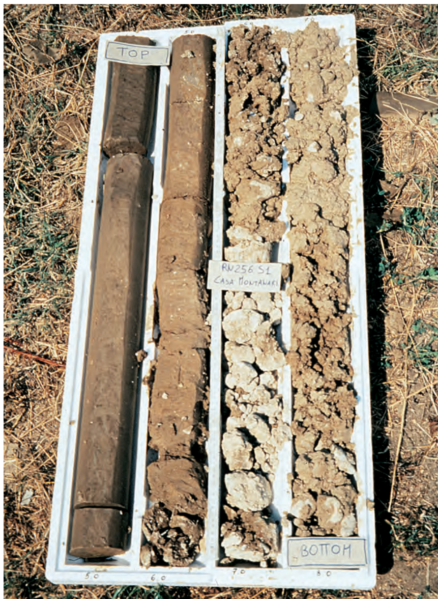
Fig. 20 - Carota del sondaggio 256-S1 (AES 8 , intervallo 4-8 m, Appendice I, "sezione superficiale" C-C'-C") effettuato a ridosso dello sbocco vallivo del F. Marecchia (Fig. 7). La foto mostra come si presenta, in un carotaggio, una situazione simile a quelle illustrate nelle Figg. 14 e 19. Si noti la chiusura netta dei depositi ghiaiosi di canale con delle tracimazioni fluviali argilloso-limose.
