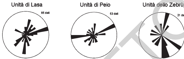
Abb. 33 - Rosendiagramm mit der Verteilung der Kluftflächen in der Ortler-Campo-Decke, Laaser- und Martelltal.
