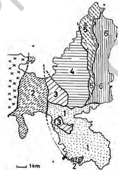
Fig. 8 - Schema dell'unità tettoniche dell'Isola d'Elba orientale. 1- Autoctono; 2- Successioni mesozoiche e paleozoiche dell'Elba centrale tra Colle Reciso e Valdana; 3- Scaglie di Flysch di Valdana e Capoliveri; 4- Complesso ofiolitico; 5- "Schuppenzone" suddivisa in tre scaglie minori (A, B, C dalla base al tetto); 6- Successioni "parautoctone" meso-paleozoiche lungo la costa orientale dell'isola. xxx- Flysch dell'Elba centrale (da BODECHTEL, 1964a).
