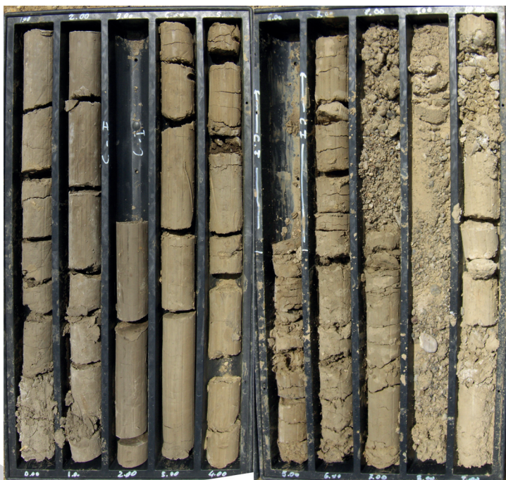
Fig. 19 - Carotaggio in località Piscitelli e Paglia. I depositi fini dell'unità NAQ costituiscono i primi 7,5 metri; al di sotto vi sono le ghiaie del subsistema dell'Incoronata (RPL).
