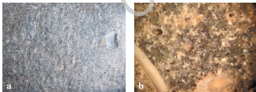
Fig. 128 - Grainstone del sondaggio S2 ( -7 \div -9 m; MIS3? - MIS5?); a) litofacies della carota prelevata; b) microfacies a lamellibranchi e foraminiferi bentonici.
