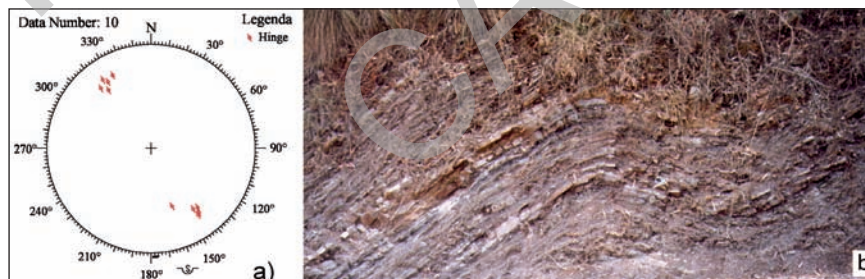
Fig. 57 – Strutture plicative lungo le anticlinali di Monte Cane e Monte S. Onofrio. L’analisi della distribuzione degli assi delle pieghe minori evidenzia un trend dominante orientato N334/24 (a). La foto (b) mostra un esempio di pieghe minori nella formazione Crisanti affioranti presso Monte Bellina. Il senso di asimmetria è coerente con i meccanismi di scivolamento flessurale che si sviluppano all’interno della piega principale che le ospita (fianco NE dell’anticlinale di Monte Cane).
