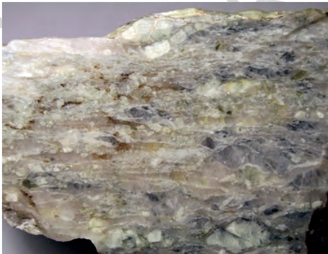
Fig. 76 - Sezione perpendicolare alla foliazione di una metapegmatite a spodumene. Da notare la tessitura milonitica a matrice fine e porfiroclasti ad "occhio", spesso boudinati e/o fratturati.
