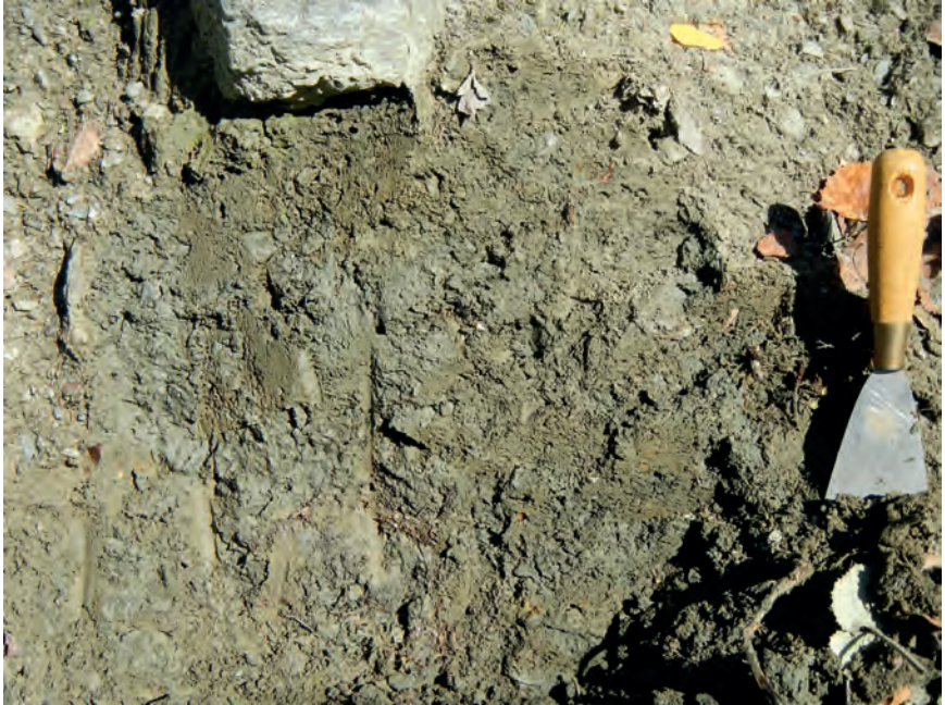
Fig. 87 - Diamicton a supporto di matrice, massivo, sovraconsolidato, interpretato come till d'alloggiamento (subsistema di Malga Fontana Bianca). Località: San Leonardo in Passiria, a N di Larcher.
