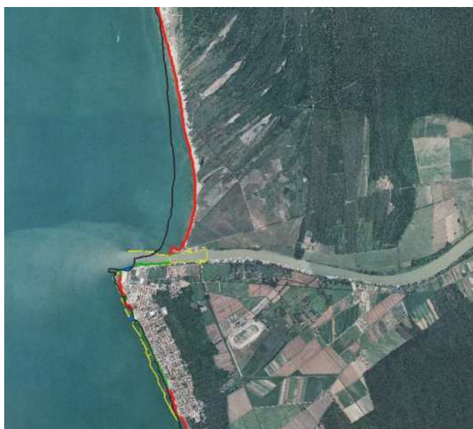
Figura 3.1.1: La sovrapposizione dei profili del litorale toscano in prossimità della foce del Fiume Arno rilevati negli anni '50 (carta IGM, scala 1:25.000, anno 1950) e nel 1998 (ortofoto VOLOIT2000) mostra la tendenza all'arretramento della linea di riva.
