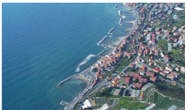
Figura 3.4.6: La prima "foto obliqua" illustra un esempio di protezione del litorale con "opere di difesa miste", costituite da barriere e pennelli disposti in varie direzioni rispetto all'andamento della linea di riva. La seconda foto (Prato Ranieri, Toscana) mostra più in dettaglio delle opere di difesa di tipo misto costituite da una barriera emersa ed un pennello, disposti obliquamente rispetto alla linea di riva secondo la direzione di propagazione del moto ondoso prevalente (Regione Toscana).
