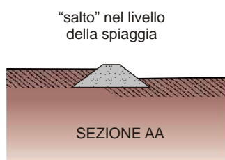
Figura 4.2.3: Esempio schematico di modifica della direzione della linea di spiaggia dopo la realizzazione di headlands. La struttura è localizzata a distanza dalla costa in posizione tale da favorire la formazione di un tombolo. Sul lato di sottoflutto della struttura, le onde diffratte e rifratte potranno determinare la formazione di una spiaggia con configurazione curvilinea che segue l'andamento dei fronti d'onda. Con una serie di strutture si formerà una linea di costa a forma dentellata.
