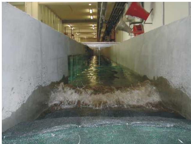
Figura 3.3.1: Modello fisico bidimensionale in canale, dal Laboratorio di Ingegneria Ambientale e Marittima dell'Università de L'Aquila.
