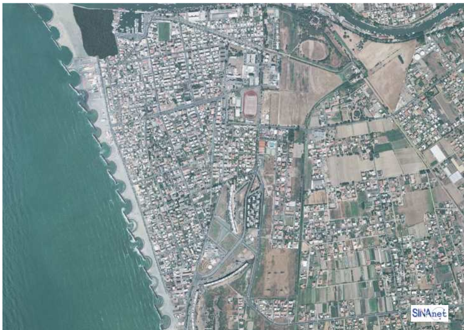
Figura 4.1.10: Roma, Comune di Fiumicino. Barriere emergenti inclinate verso la direzione della corrente litoranea prevalente. Questo tipo di opere, molto impiegato negli anni '60-'80 sul litorale laziale, viene realizzato allo scopo di contrastare l'azione diretta del moto ondoso e di favorire la formazione di nuova spiaggia. Terral Italy it2000™ © C.G.R. S.p.A. PARMA
