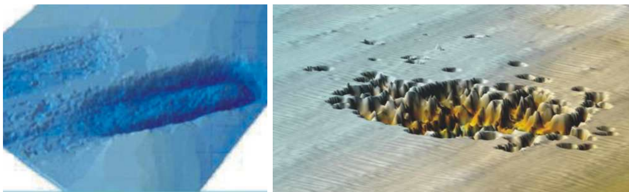
Figura 4.4.4: Immagini morfobatimetriche dei fondali della cava marina di Anzio (a sinistra) e di Montalto di Castro (a destra) ottenute per elaborazione dei dati acquisiti con tecnologia multibeam. (Foto ICRAM).
