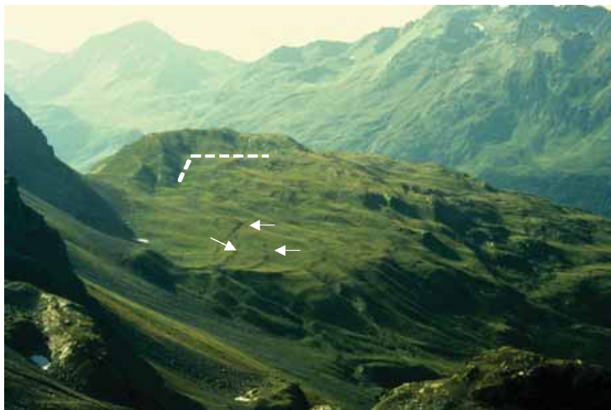
Figura 1.40 – Vista di una dorsale interessata da deformazioni gravitative profonde evidenziate dalla presenza di alcuni caratteristici elementi geomorfologici quali: la scarpata situata nella parte alta del versante rivolta verso valle, corrispondente ad un piano estensionale ad alto angolo (evidenziata con una linea tratteggiata blu), le numerose trincee (alcune delle quali sono evidenziate dalle frecce) e i vari fenomeni franosi posti nella parte bassa del versante. Località Costa del Bosco del Conte, in alta Valtellina, comune di Bormio (SO).
