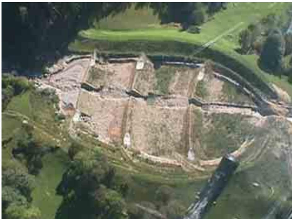
**Figura 7.1.11:** Casse di ritenuta in cemento armato poste ai lati del canale di convogliamento delle colate. La gradonatura del fondo del canale rallenta le colate e favorisce il riversamento nelle casse di ritenuta. (Quindici AV)
