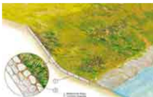
**Figura 6.4.25:** L'intasamento dei materassi con il terreno viene effettuato con l'escavatore idraulico e parte dalla sommità procedendo verso il basso. Questa operazione va effettuata prima di chiudere il coperchio del materasso in rete metallica.
