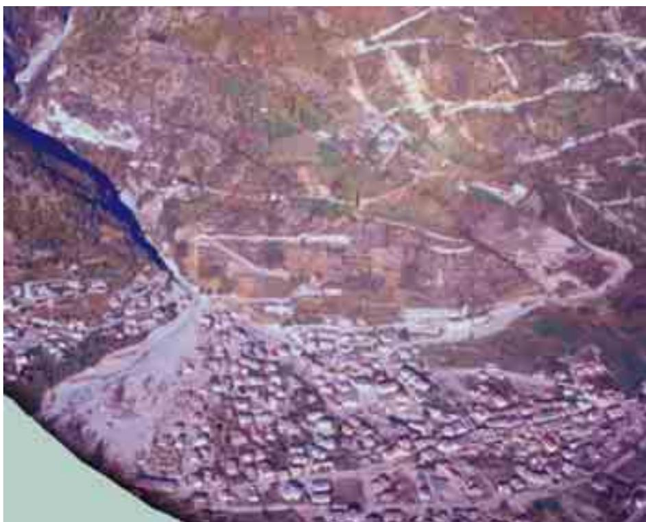
**Figura 7.0.2:** Effetti devastanti di una colata detritica. La massa enorme di fango e detrito che si muove rapidamente ha una forza di impatto fino a 60 kN/mc (forza per unità di volume di colata). I blocchi presenti nella colata possono però generare forze impulsive puntuali con intensità fino a 10.000 kN a seconda della rigidità delle opere impattate.
