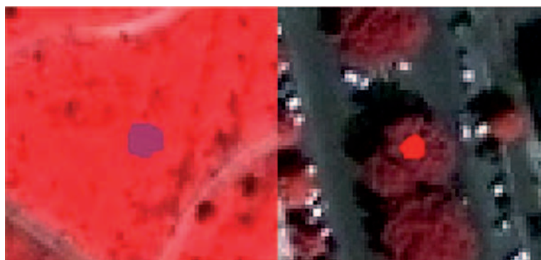
Figura 28 – Aree di training. A sinistra, in colore porpora, è rappresentata una ROI che definisce la classe 'Prati e cespugli'. A destra, in colore rosso, è rappresentata una ROI della classe 'Conifere'. L'immagine è visualizzata in falsi colori (sintesi 4-3-2).
