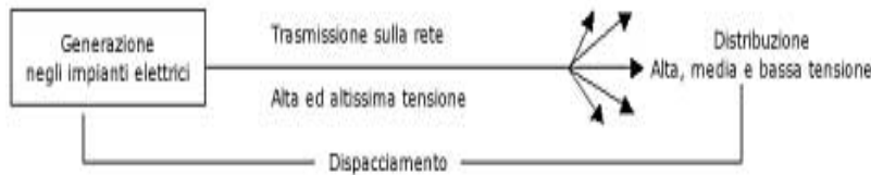
Figura VI-1 – Schema a blocchi del sistema elettrico italiano
