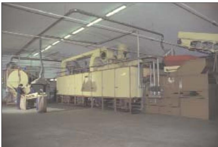
Figura 5. Essiccatore "orizzontale" a circolazione forzata d'aria.
