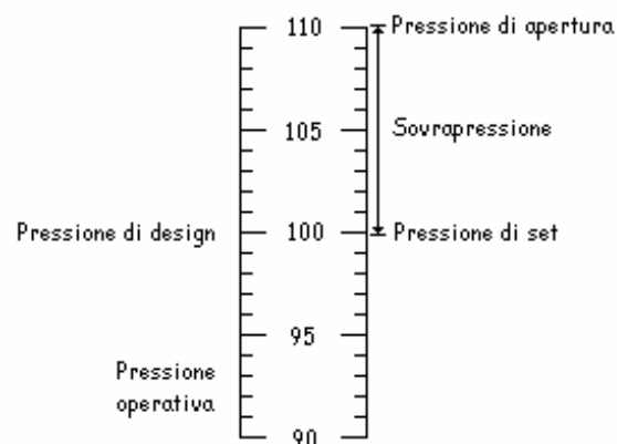
Figura 11.2 Valori limite di pressione che caratterizzano una valvola di sicurezza a molla
