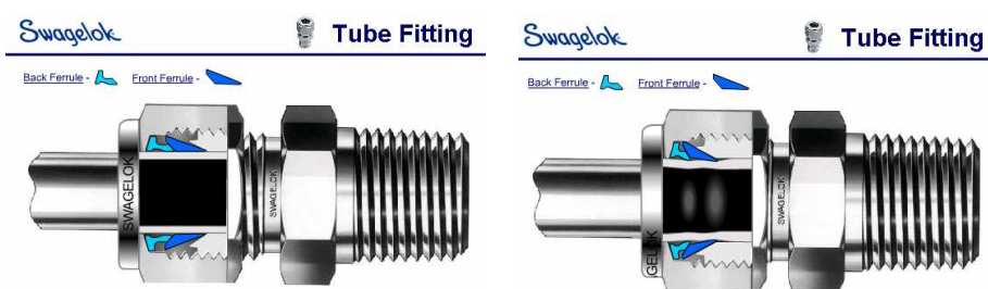
Figura 6.6 Schema di funzionamento dei giunti Swagelok
