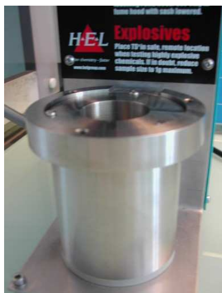
Figura 6.3 Particolare del forno cilindrico di riscaldamento all'interno del quale si inserisce la cella portacampione.
