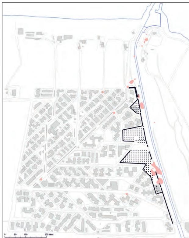
Fig. 13 - Distribuzione planimetrica delle perforazioni di iniezione eseguite nell'area di Lesina Marina prospiciente il canale. Le aree colorate in rosa corrispondono all'inviluppo dei cluster di espansione dei sinkholes.
