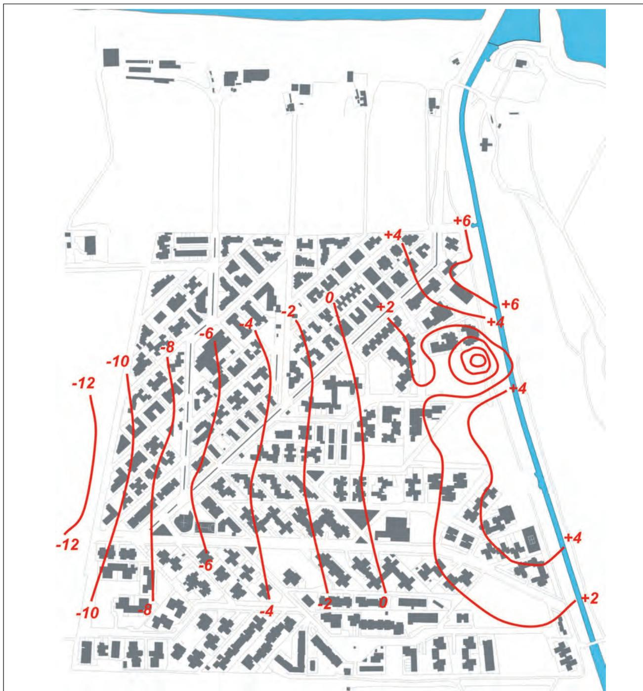
Fig. 6 - Isovalori del tetto del bedrock locale evaporitico.
