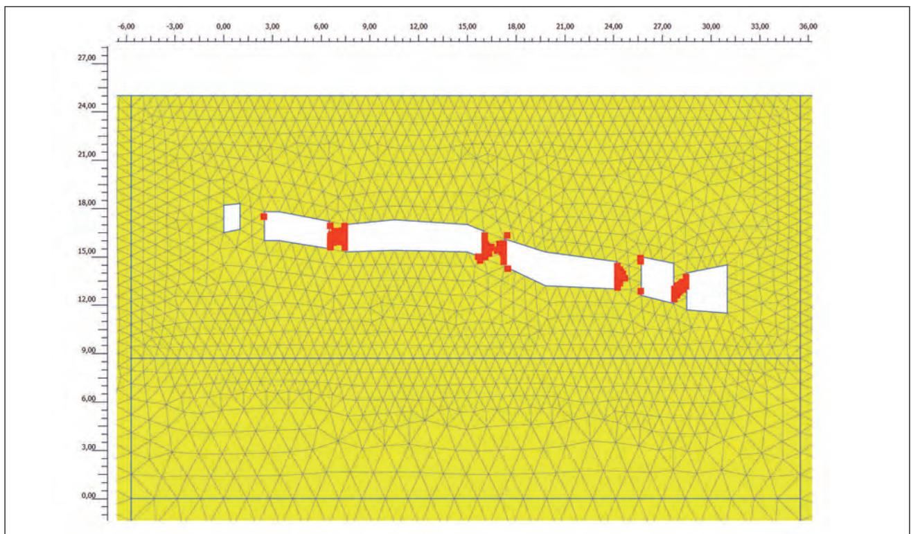
Fig. 11 - Analisi 2 (calcareniti con grado di saturazione  $S = 1$ ; GSI = 95): zone di plasticizzazione nei pilastri che delimitano le camere di coltivazione.
