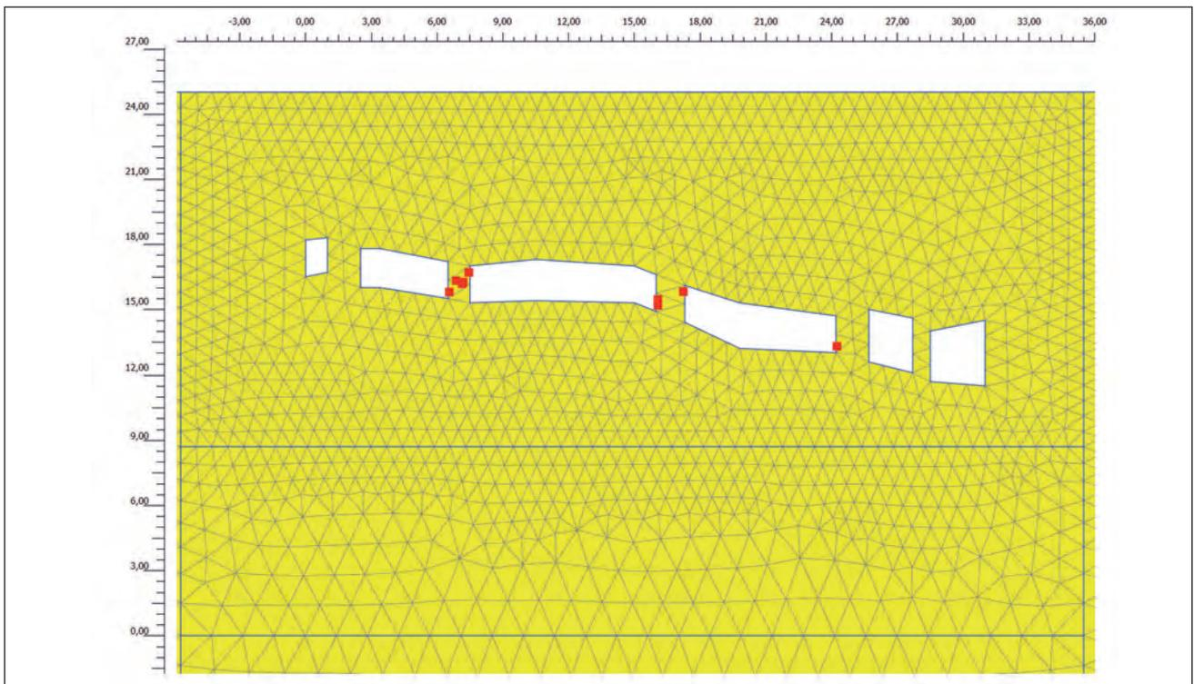
Fig. 9 - Analisi 1 (calcarenite con basso grado di saturazione; GSI = 95): zone di plasticizzazione nei pilastri che delimitano le camere di coltivazione.
