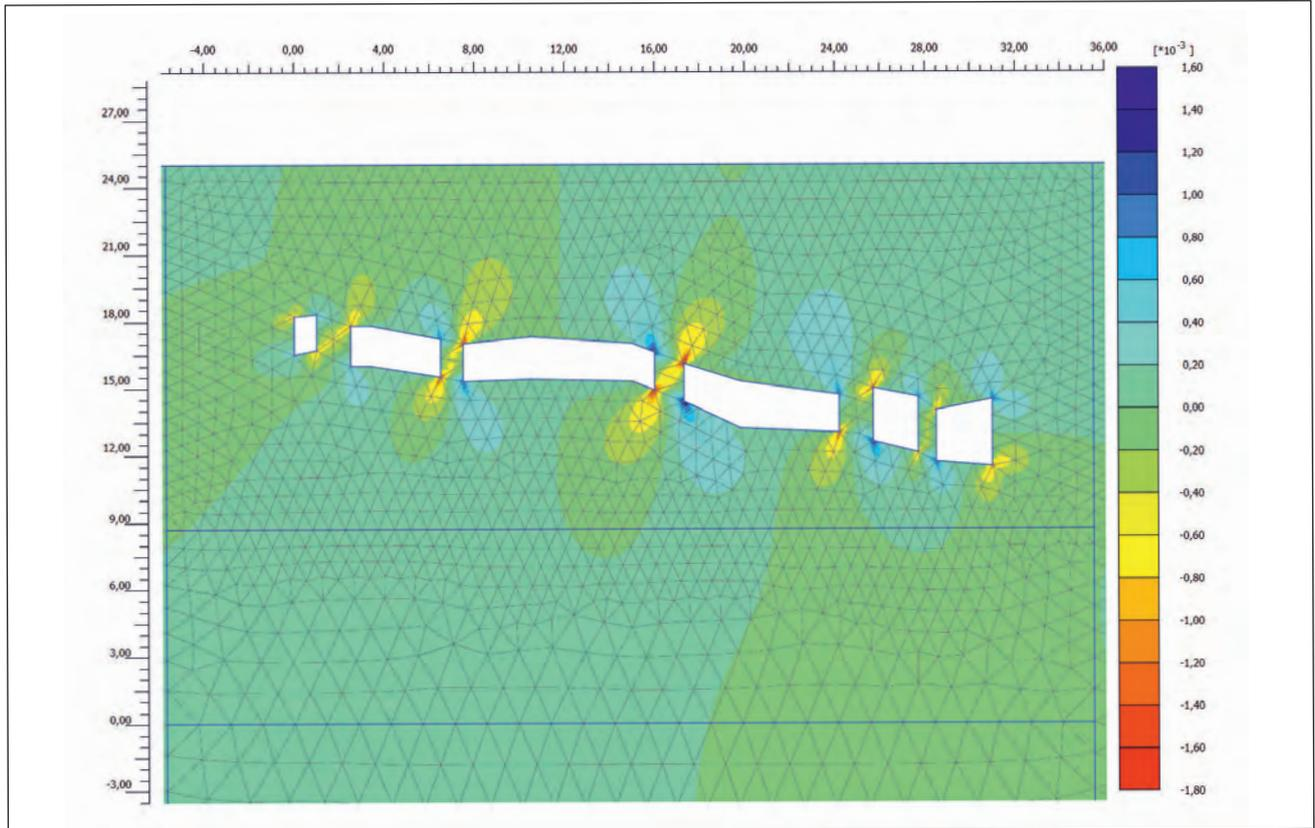
Fig. 10 - Analisi 1 (calcareniti con basso grado di saturazione; GSI = 95): accumulo di deformazioni di taglio nelle stesse aree del dominio di calcolo.
