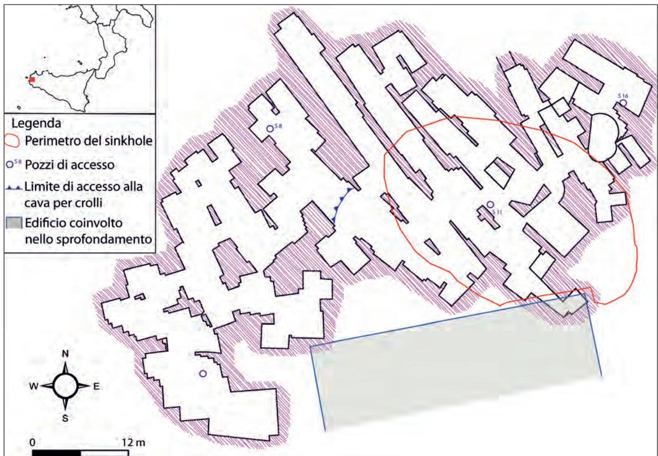
Fig. 1 - Rilievo topografico della cava oggetto di studio con indicazione del perimetro del sinkhole. Nel riquadro localizzazione dell'area.
