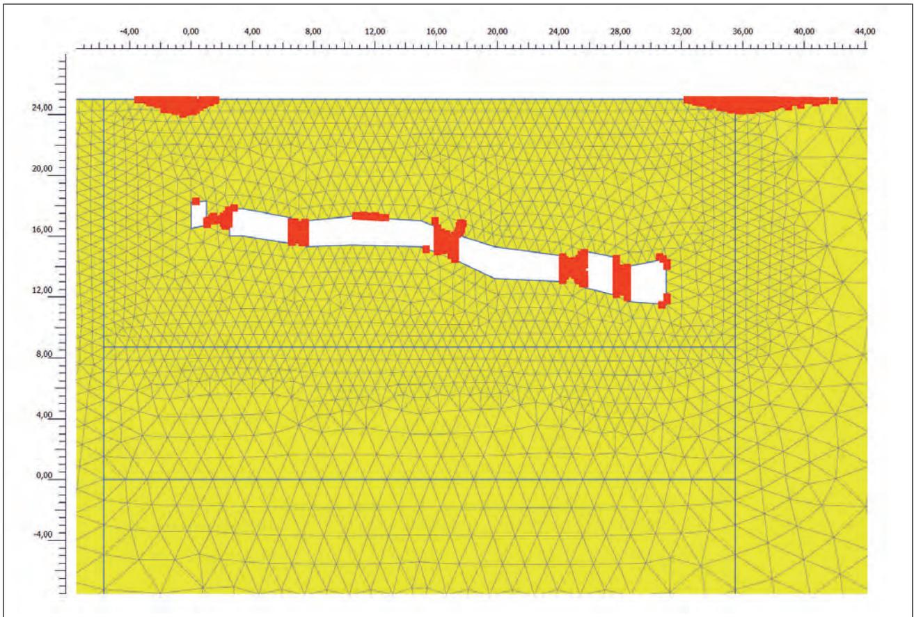
Fig. 14 - Analisi 3 (calcarenite con grado di saturazione  $S = 1$ ;  $GSI = 80$ ): zone di plasticizzazione nei pilastri che delimitano le camere di coltivazione.
