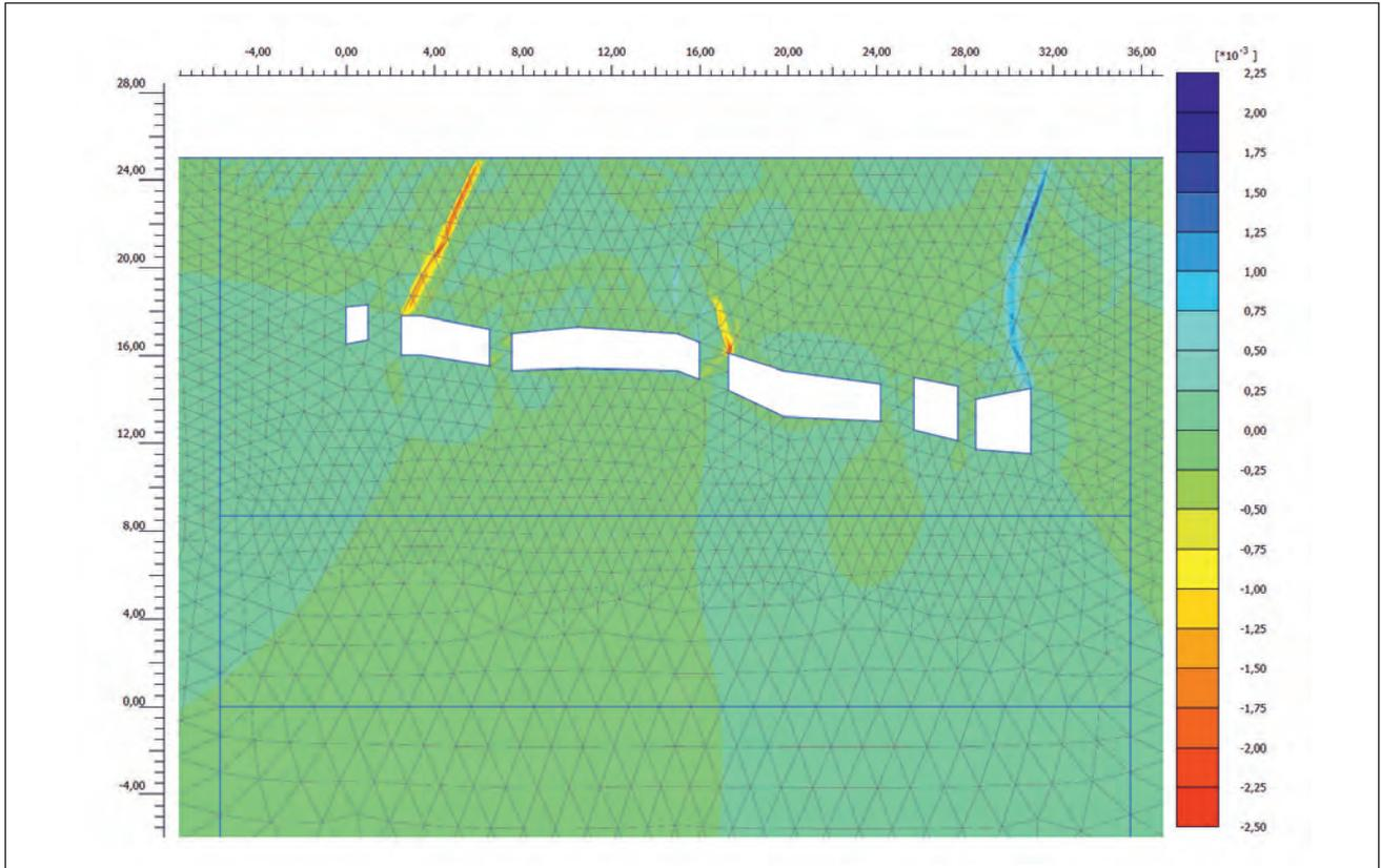
Fig. 12 - Analisi 2 (calcareniti con grado di saturazione  $S = 1$ ;  $GSI = 95$ ): accumulo di deformazioni di taglio nelle stesse aree del dominio di calcolo.
