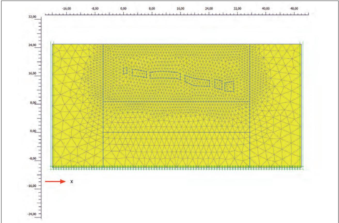
Fig. 8 - Sezione di calcolo (sezione 6, per l'ubicazione vedi figura 7) e maglia di discretizzazione considerate per l'implementazione del modello agli elementi finiti.
