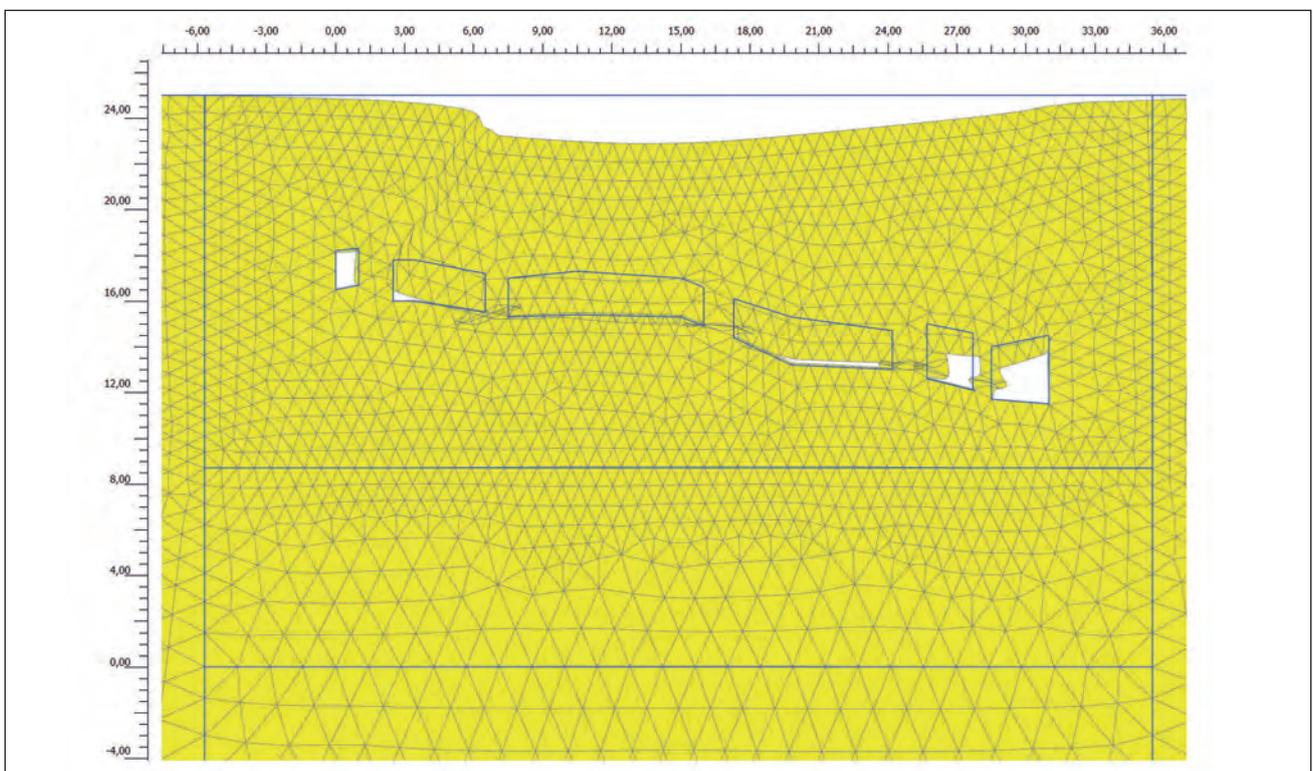
Fig. 13 - Analisi 2 (calcareniti con grado di saturazione  $S = 1$ ;  $GSI = 95$ ): maglia deformata della superficie topografica conseguente al collasso.
