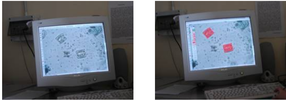
Figura 1.21 – Sistema di analisi immagine con identificazione (sinistra) e cattura manuale (destra) delle alghe
