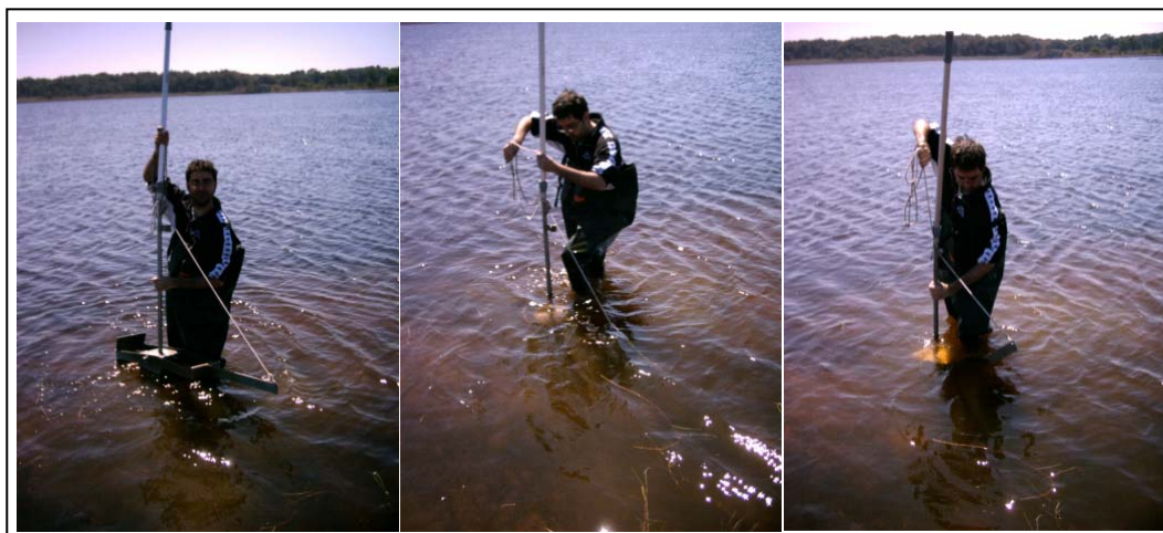
Figura 2.2 – Sequenza delle fasi con cui viene utilizzato un box corer manuale da un operatore deambulante. In successione da sinistra verso destra si osserva la fase di apertura e posizionamento del box corer, l’inserimento del box corer nel sedimento ed infine la fase di chiusura.
