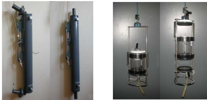
Figura 1.3 – Bottiglia Niskin (sinistra) e bottiglia di Ruttner (destra) chiuse e aperte.
