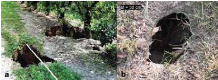
Fig. 2 - Sprofondamento del Piano di Campagna: SPC (a) e cavità stretta (b). La foto in (a) è tratta da Provincia di Bologna (2002).
