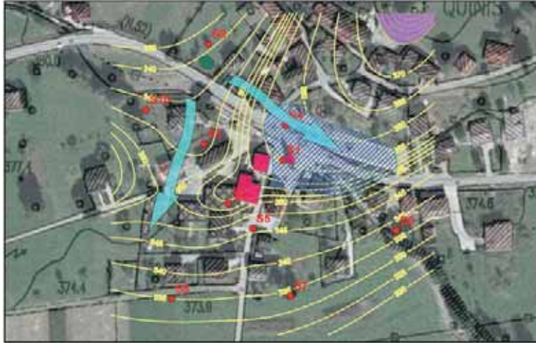
Fig. 4 - Dissesti ed andamento del substrato evaporitico [gessi e silti gessose del Carnico] nel sotto-suolo dell'abitato di Quinis posto su un terrazzo alluvionale a quote variabili fra 374 e 375 m s.l.m. (area 3 nella fig. 1). In giallo le isobate del bedrock in metri s.l.m.; in viola gessi in affioramento; in verde una dolina alluvionale. Le frecce blu indicano le direzioni preferenziali di trasferimento della fluoresceina. In rosso gli edifici con lesioni recenti, a righe blu l'area ove sorgevano gli edifici distrutti nel 1800, in rosso i piezometri.
