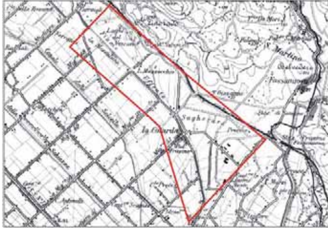
Fig. 2 - Area di inedificabilità del P.R.G. di Pontinia (LT) per la presenza di fenomeni di subsidenza e sprofondamento, con substrato carbonatico posto a profondità comprese tra 100 m e 120 m dal piano campagna.
