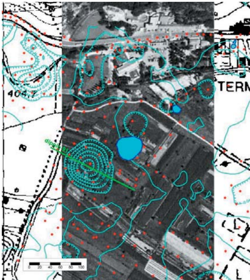
Fig. 4 - Rilievo microgravimetrico della Piana di San Vittorino: sono riportate unicamente le isonome con valore negativo e sulla zona marcata da un forte minimo gravimetrico, -0.200 \text{ mGal} è riportata la traccia di una tomografia elettrica (figura 5).
