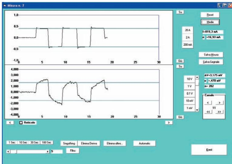
Fig. 2 – Esempio di un segnale disturbato da una condotta metallica
