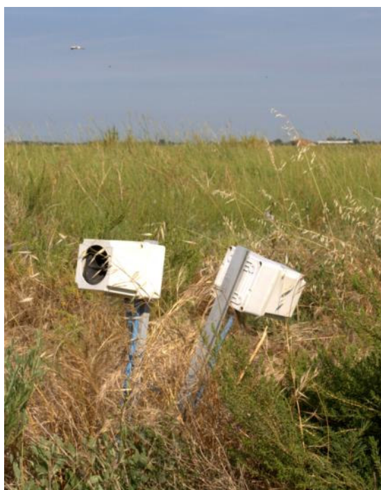
Fig. 34 - Acoustic devices employed in the Cervia saltans gull scaring. | Dispositifs de dissuasion bioacoustiques pour effaroucher les goélands dans les marais salants de Cervia .
