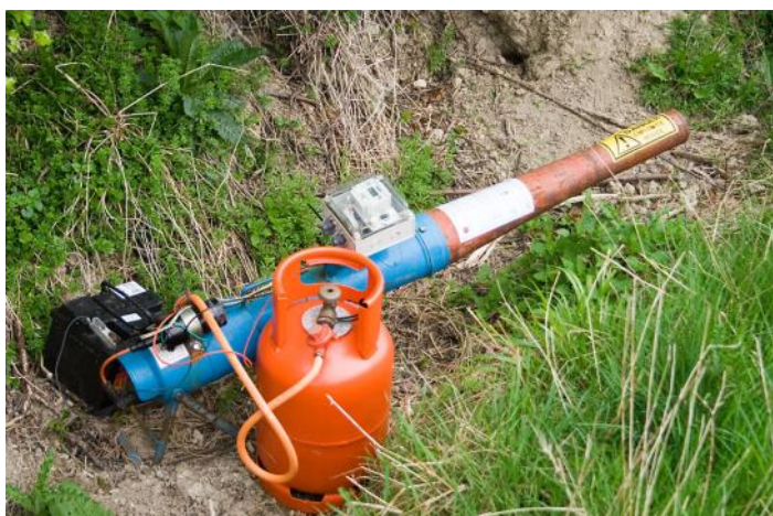
Fig. 35 - Gas cannon for bird deterrence | Canon à gaz effaroucheur pour faire fuir les oiseaux.
