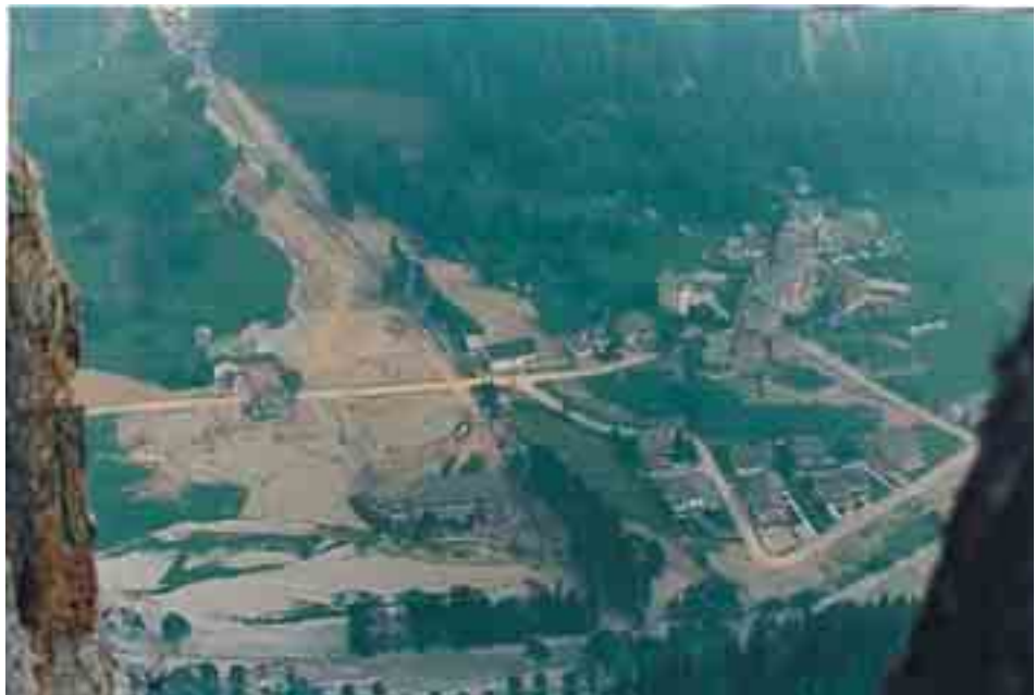
Figura 5.0.2: Esondazione dovuta ad eccesso di trasporto solido e sovralluvionamento in zona di conoide. Il deposito del trasporto solido in corrispondenza della rottura di pendenza presso lo sbocco a valle del torrente, dà luogo all'innalzamento del fondo e conseguente esondazione. Oltre a questo fenomeno, spesso in queste condizioni, si riversano a valle le colate di fango o di detrito che si innescano nelle parti alte dei bacini, con conseguenze che possono essere devastanti. (Vallescura, BG)
