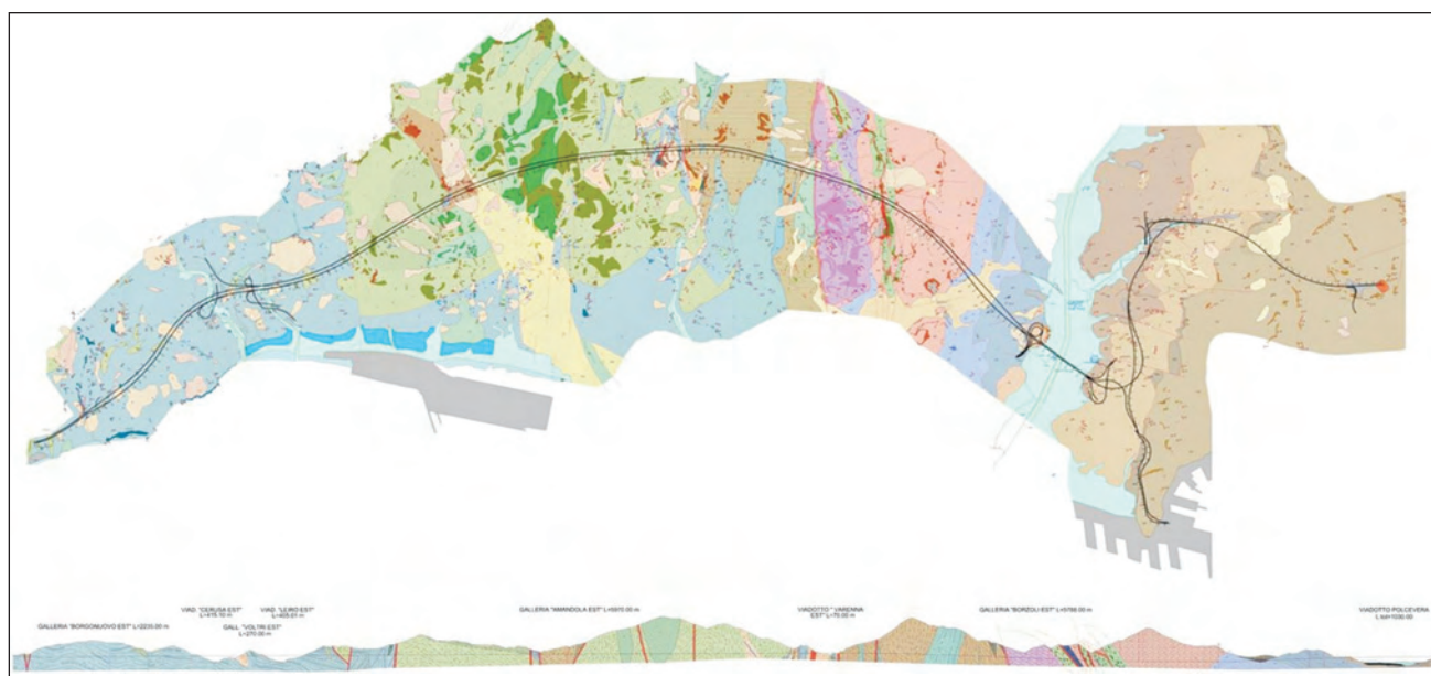
Fig. 2 - Progetto preliminare potenziamento del Nodo di Genova (planimetria e profilo geologico). SPEA Ingegneria Europea 2008. - Gronda di Genova, geological advanced preliminary project. SPEA Ingegneria Europea 2008.
