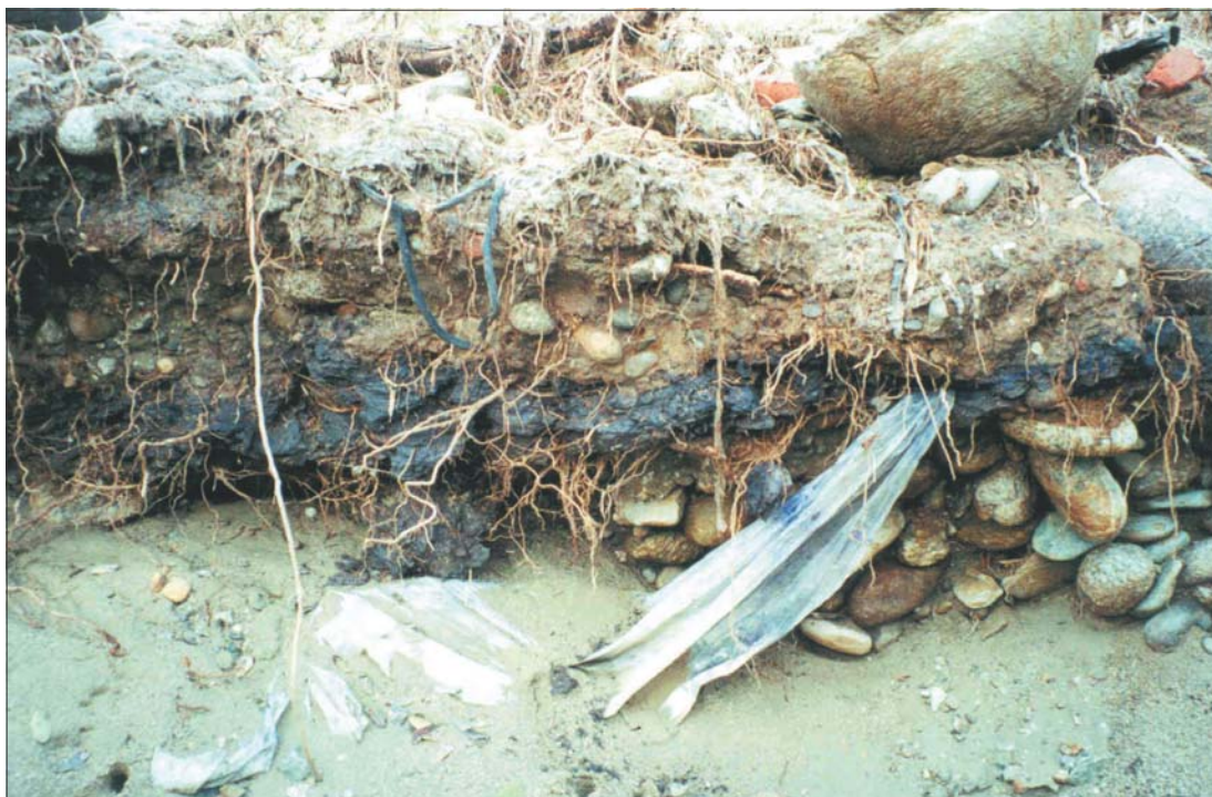
Foto 1-3: Particolare dei rifiuti esposti dall'erosione fluviale. Il livello di colore nero è composto da fanghi disidratati inodori e poggiati direttamente sul substrato alluvionale ghiaioso - sabbioso.
