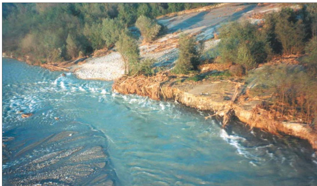
Foto 1-1: Discarica S.A.L.P. di Vercellino – Rivarolo C.se Torino. Ripresa dall'alto dell'area interessata dall'onda di piena del T. Orco. In primo piano si nota il ramo principale della corrente che determina fenomeni di erosione laterale. (Ripresa fotografica effettuata il 17/10/2000 dell'area della discarica - per gentile concessione Comune di Rivarolo).
