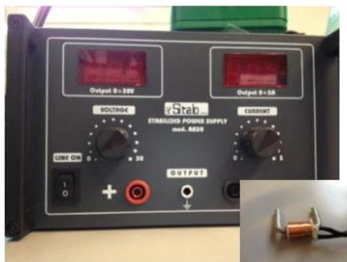
Figura 2 – Alimentatore stabilizzato (Stab mod. AR30) provvisto di magneti per l'esposizione degli organismi.
