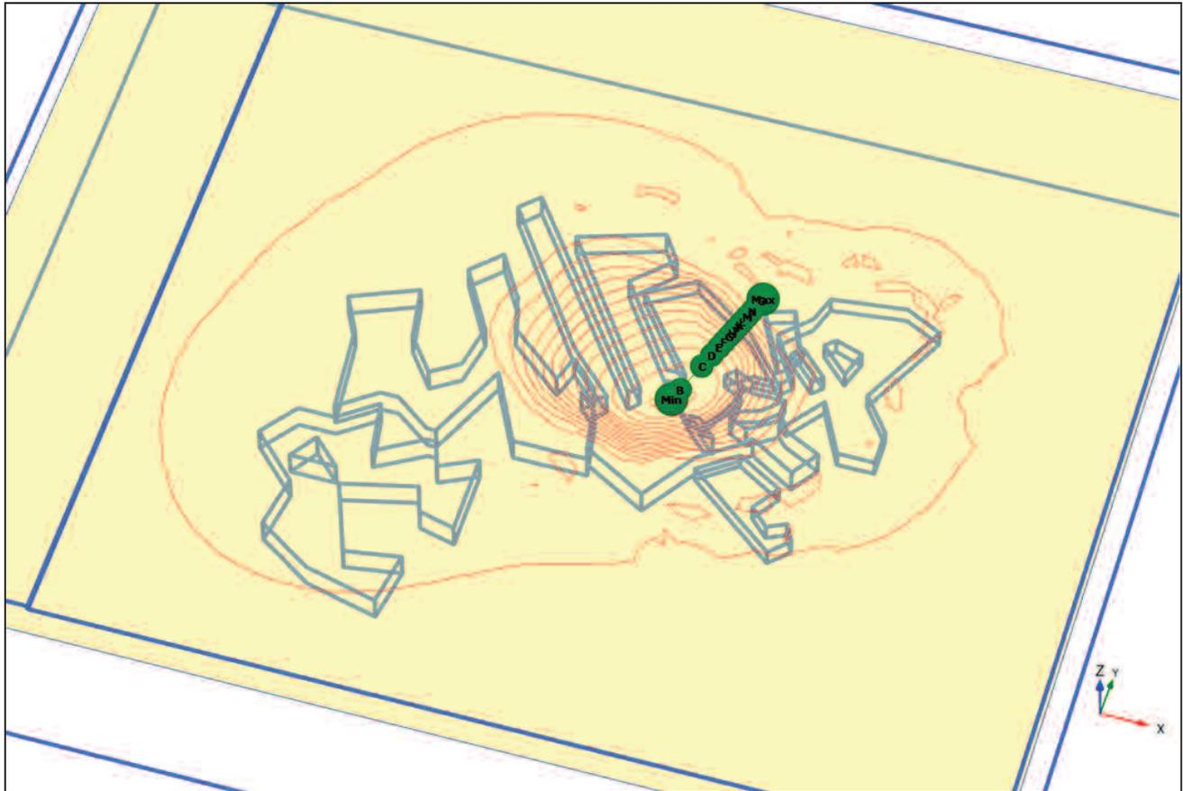
Fig. 6 - Isolinee degli spostamenti verticali nel modello tridimensionale ricostruito per lo sprofondamento della cava nei pressi dello stadio comunale a Marsala (BONAMINI *et alii*, 2013; VATTANO *et alii*, 2014).
