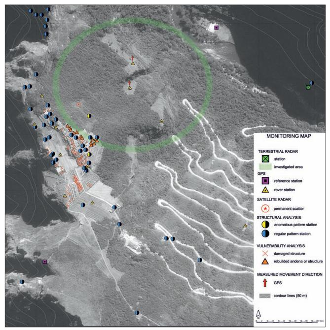
Fig. 5 – Integrated map of surface deformation evidences and present monitoring data. – Mappa integrate delle evidenze delle deformazioni superficiali e del sistema di monitoraggio.
