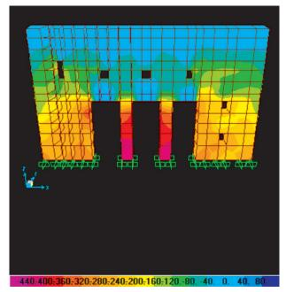
Fig. 12 – Structural analysis of the Biet Amanuel Church showing a load, in the central pillars, of about 4,5 KPa despite of a UCS of 50 KPa. *Analisi strutturale della chiesa di Biet Amanuel che evidenzia un carico nei pilastri* centrali di circa 4,5 KPa rispetto a un UCS di 50 KPa.
