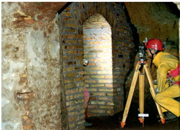
Fig. 2 - Esecuzione dei rilievi con il tacheometro Salmoiraghi modello TH11.
