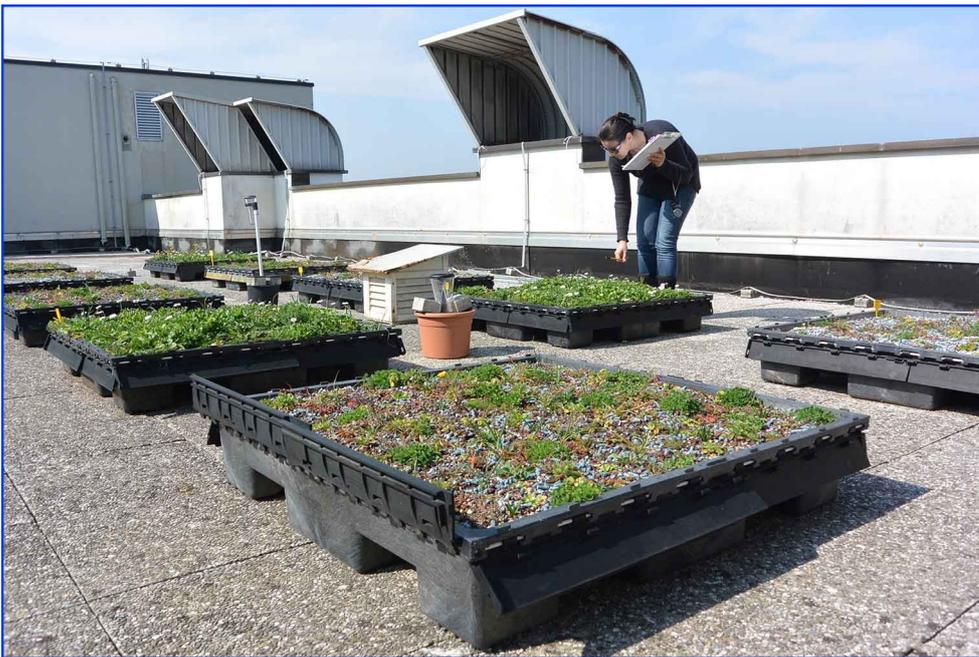
Figura 3. Prova sperimentale per verificare il rapporto tra fertilità del substrato e composizione della vegetazione su tetto verde estensivo presso l'Area della Ricerca del CNR di Pisa (Foto di F. Bretzel).
