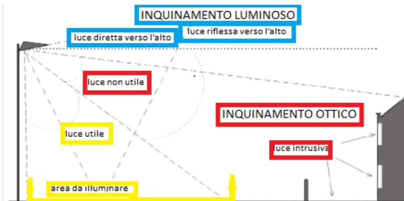
Figura 19 – Schema esplicativo inquinamento ottico e luminoso
