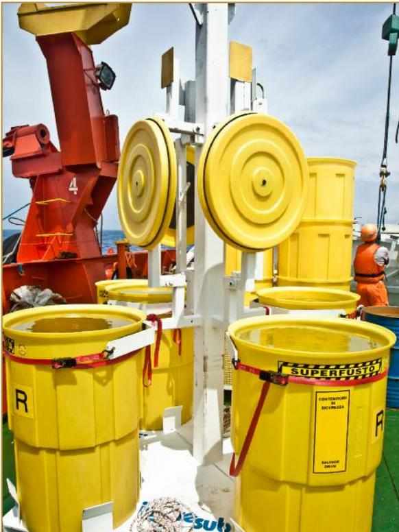
*Figura 2 - Salvage Drum - tipologia di fusto impiegato nelle operazioni di recupero di colli dispersi in mare.*
