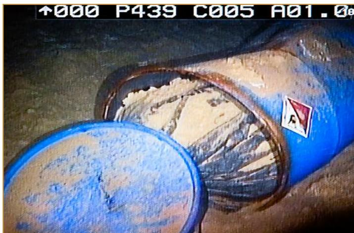
Figura 5 - Fusto da 220 litri in acciaio e tappo removibile affondato a seguito di incidente con perdita di carico in mare. Il materiale pericoloso trasportato era contenuto in un sacco in HDPE posto all'interno del fusto.
