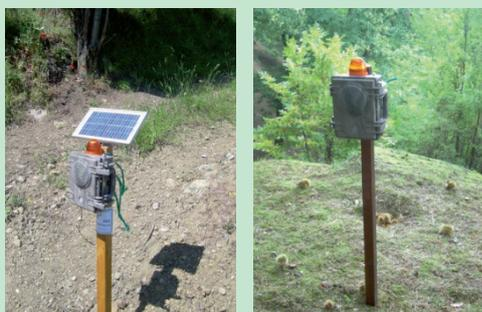
Figure A e B - Dissuasore ottico-acustico del tipo Alarm Guard. Foto di S. Innocenti.
