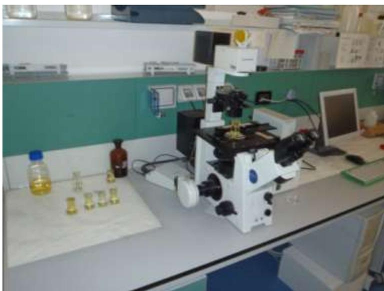
**Figura 12.4** - Microscopio ottico invertito e camere di sedimentazione.
