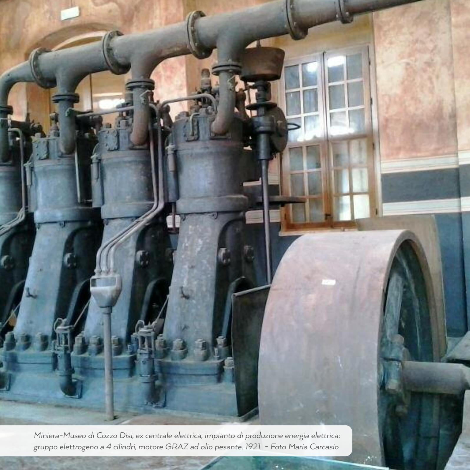
*Miniera-Museo di Cozzo Disi, ex centrale elettrica, impianto di produzione energia elettrica: gruppo elettrogeno a 4 cilindri, motore GRAZ ad olio pesante, 1921 - Foto Maria Carcasio*
