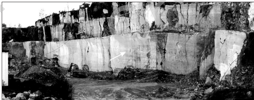
Fig. 17 - Cava attiva nei travertini s.s. del Sintema di Poggio Moiano (UPM) . Sul fronte di cava si notano grandi stratificazioni incrociate a basso angolo, con terminazioni ad onlap . Il travertino s.s. qui affiorante è prodotto per deposizione bioindotta su muschio e altri vegetali inferiori. La macchina escavatrice costituisce la scala.
