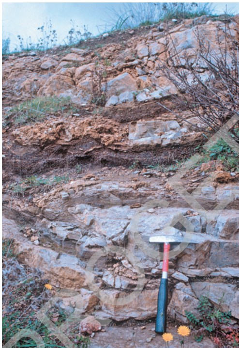
Fig. 23 - Alternanza di calcari fetidi (grigi chiari), strati di lignite (neri) e arenarie (giallastre) del Lignitifero. Si noti la faglia inversa (a sinistra e in corrispondenza del martello) con rigetto decimetrico, immergente a N075 di 40°. Campo di calcio di Serbariu, coord.: 6020-3507.
