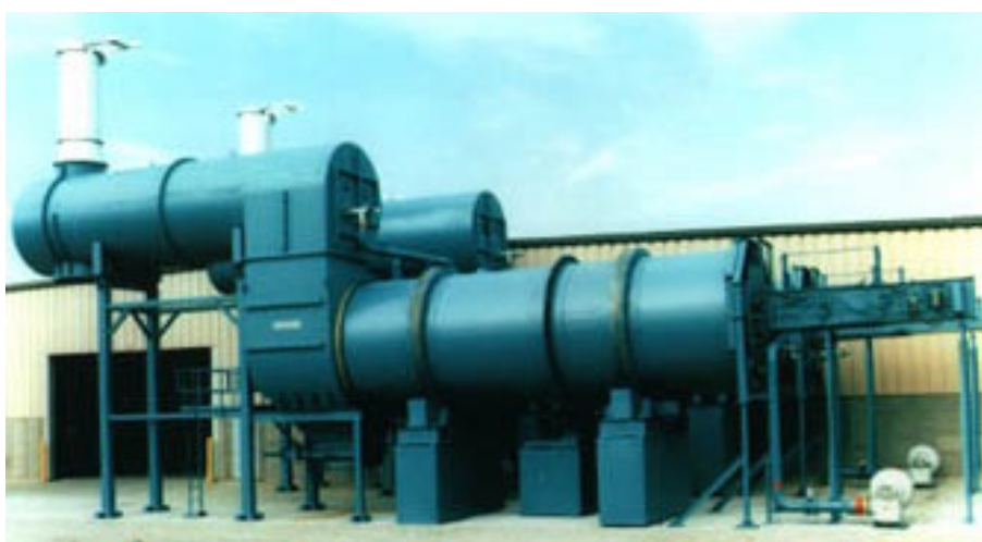
Fig.1 : Inceneritore a forno rotante
