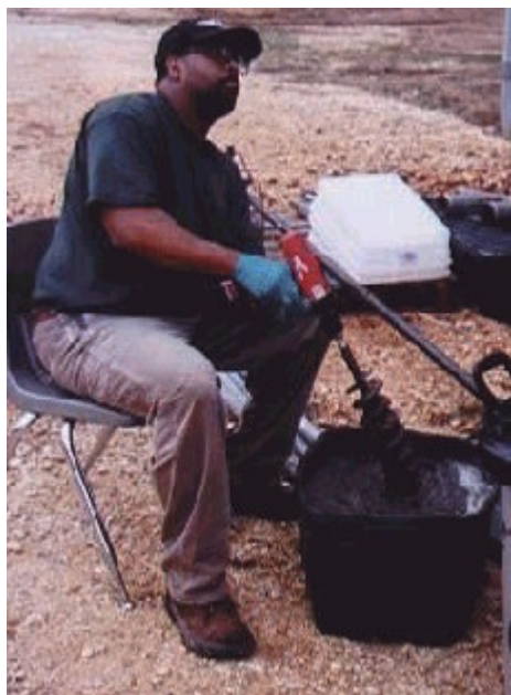
Fig. 10 : Omogeneizzazione di un campione composto con un mixer meccanico
