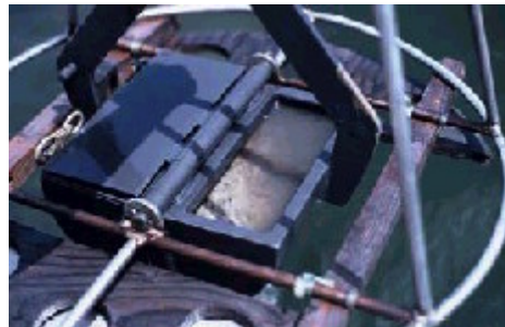
Fig. 7: Armatura di supporto di un campionatore Van Veen (modificato Ted Young). E' visibile la copertura mobile che permette il prelievo diretto del campione, che risulta ricoperto da un sottile strato d'acqua che ne garantisce l'integrità.
