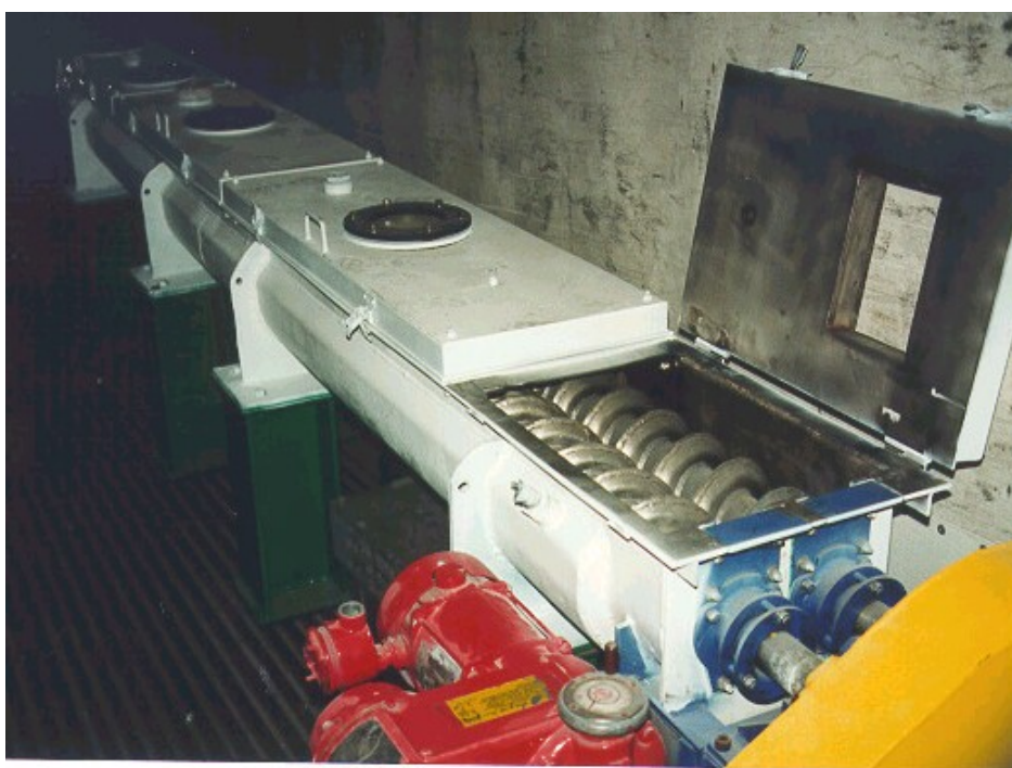
Fig.6: Processore Termico ad elevata temperatura
