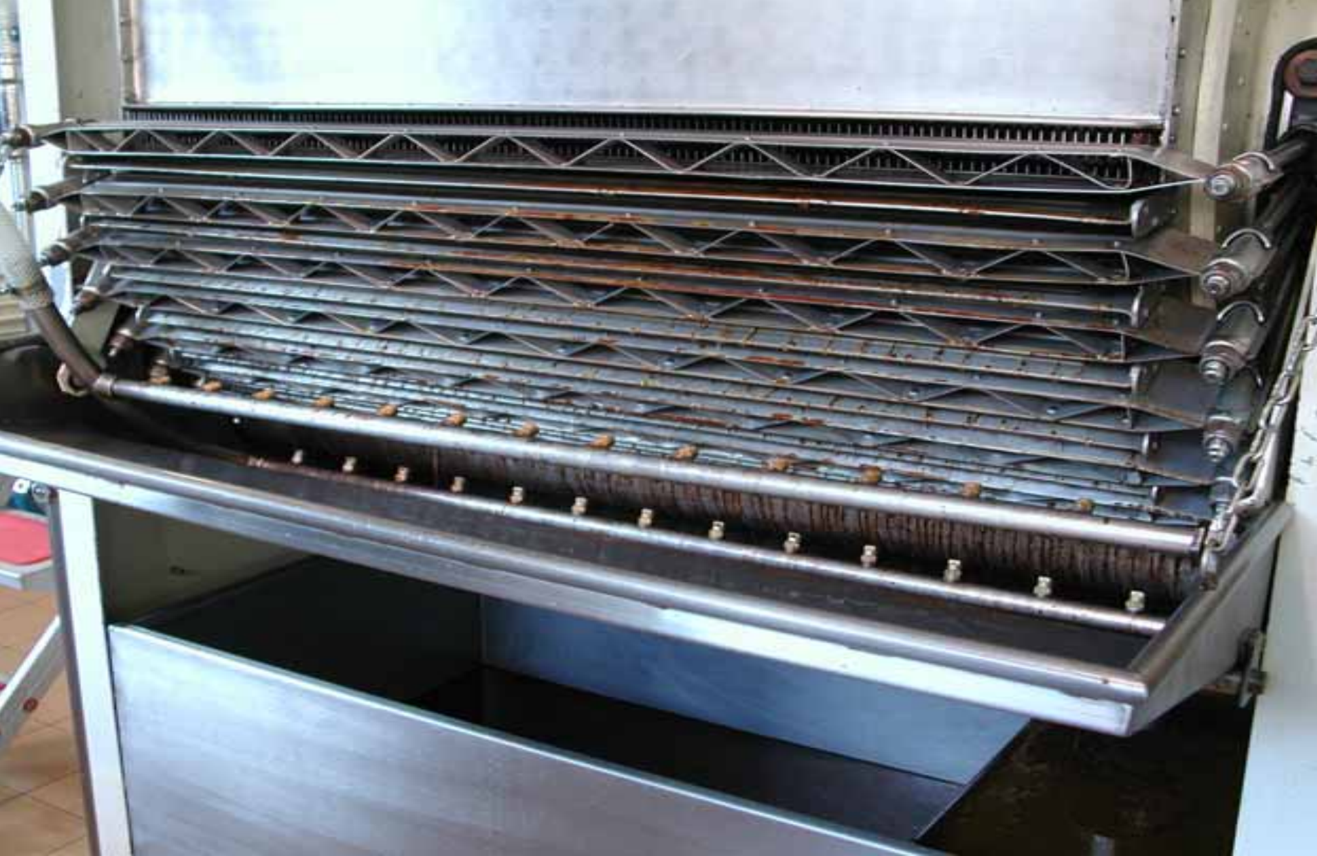
Estrazione per percolamento (Sinolea)
