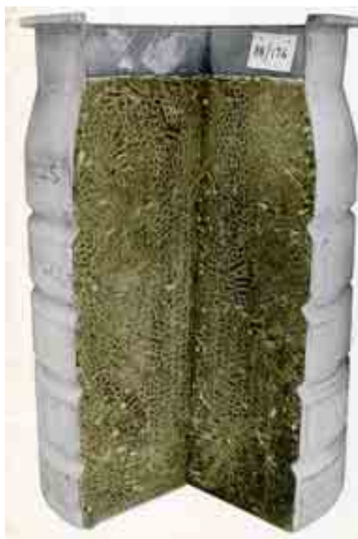
Figura 9.1: Waste package cementato tipo MAGNOX.
