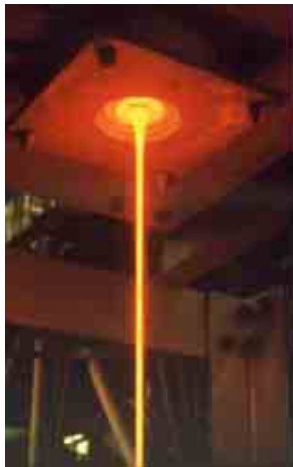
Figura 1.1: Vetrificazione di un rifiuto di III Categoria o HLW.
