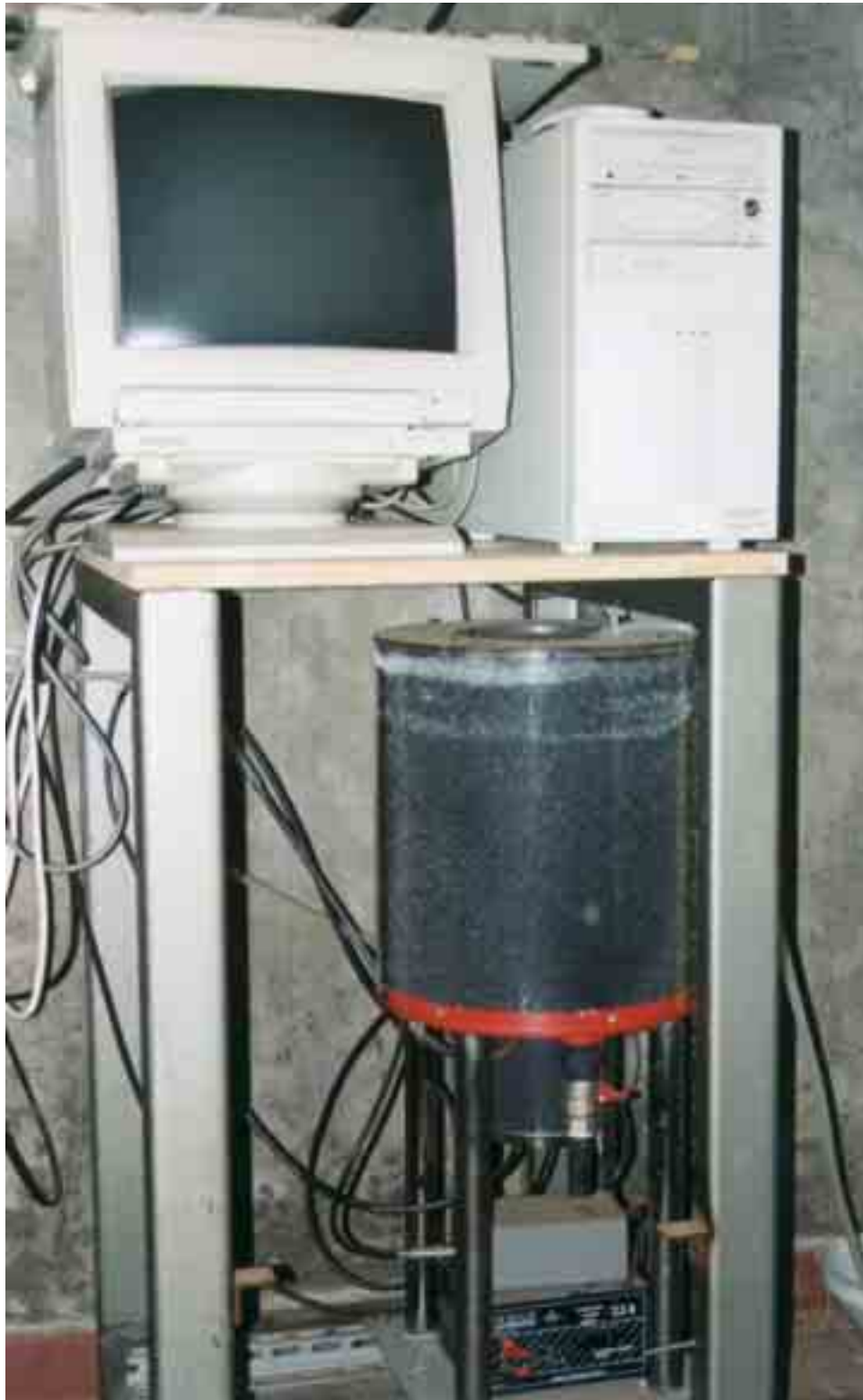
Figura 5.3 - Sistema di monitoraggio mediante spettrometria \gamma
