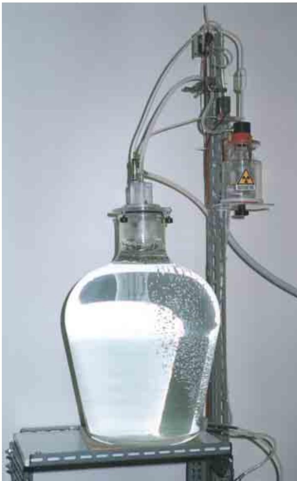
Figura 2.5 - Foto del sistema per l'arricchimento di radon in acqua
