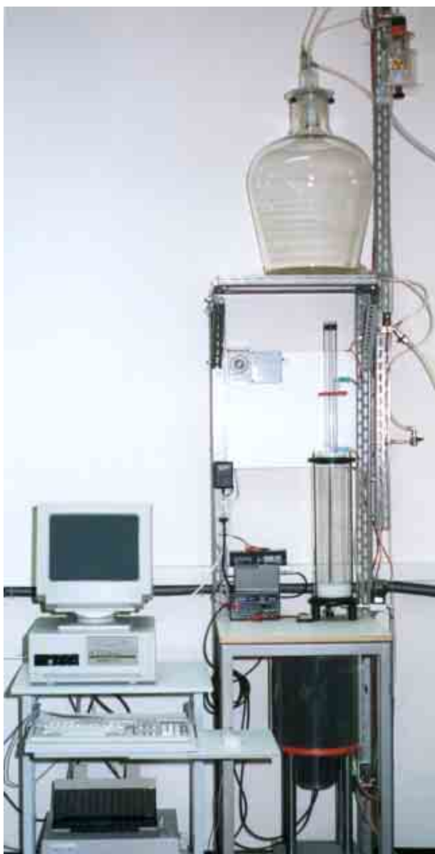
Figura 2.1 - Sistema \gamma per la misura della concentrazione di radon acqua
