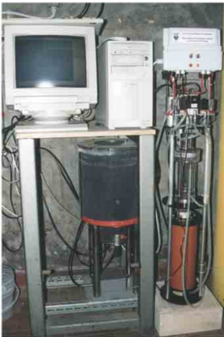
Figura 6.4 - Sistema di monitoraggio mediante spettrometria \gamma e scintillazione \alpha
