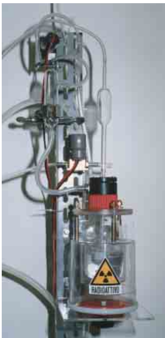
Figura 2.6 - Sorgente impiegata per la produzione di radon
