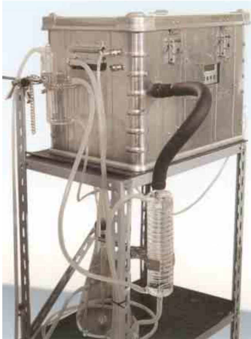
Figure 6: Photo of the radon continuous monitor designed and developed by Istituto Nazionale di Geofisica (Quattrocchi et al., 1997).
