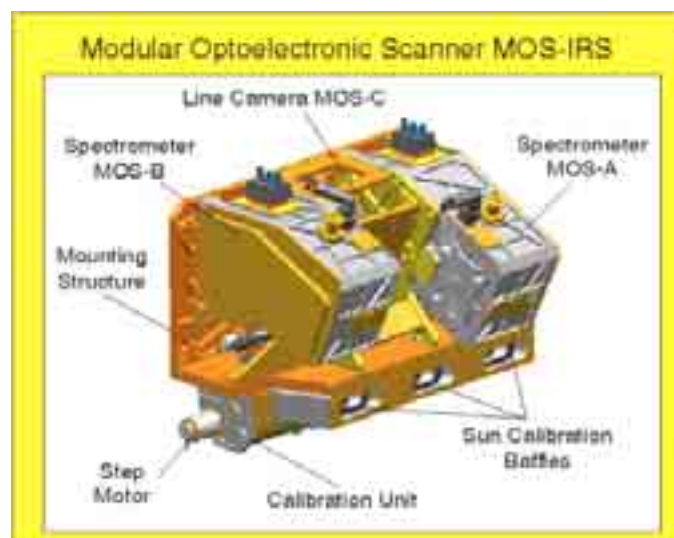
Figura 1.6-3: particolare del sensore MOS.
