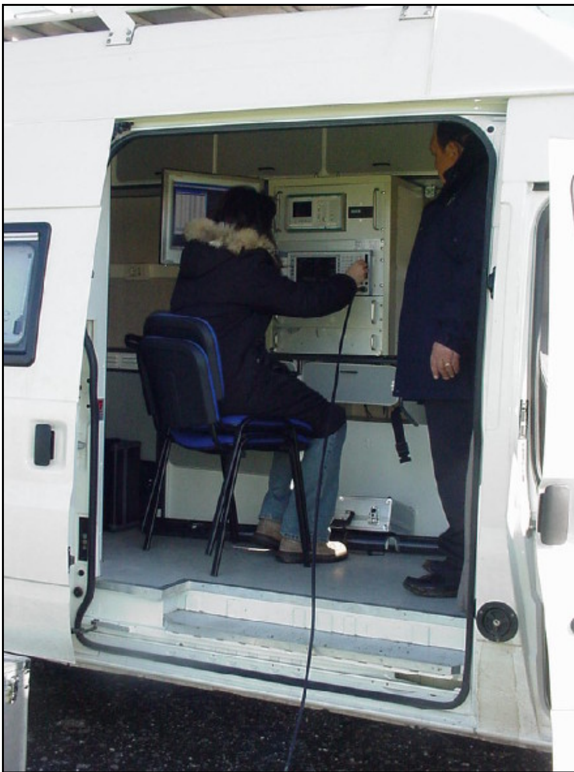
Figura 30 – Analisi delle frequenze tramite analizzatore di spettro Anritsu MS2661C
