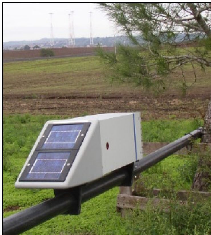
Figura 24 – Immagine di una centralina di misura dei campi elettromagnetici
