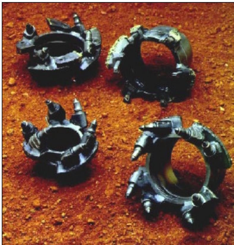
Fig. 21 – Teste fresanti (da Boart Longyear)
