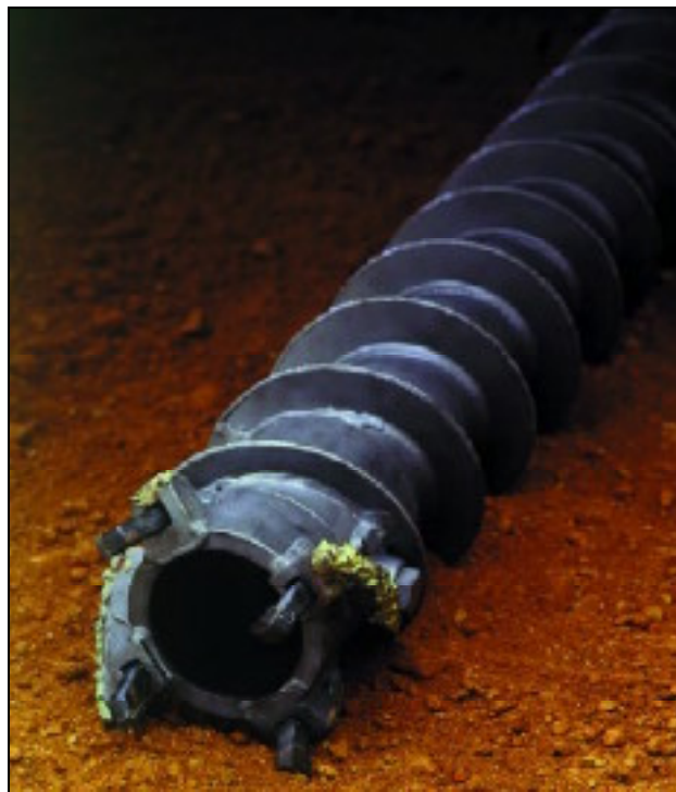
Fig. 20 – Trivella ad asta cava (da Boart Longyear)
