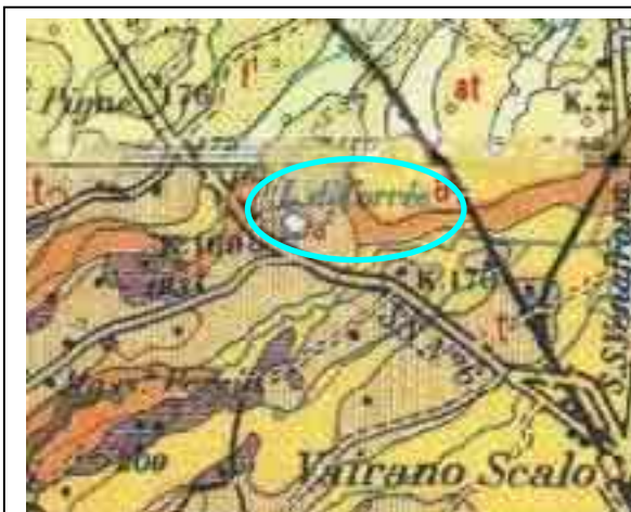
Fig. 5.3: dettaglio del lago delle Corree dalla carta geologica di Fig. 5.0. Legenda: a²: sedimenti palustri delle fosse Annunziata e Corree; i: ignimbrite da trachitica a trachifonolitica (“tufo grigio campano” Auct.); t: banchi di tufiti ocracei e paleosuoliti con intercalazioni di alluvioni ghiaioso-sabbiose, tufiti giallognoli, sabbie vulcaniche grigiastre; at: sabbie e limi grigi e giallastri, stratificati, incoerenti; tt: tufi cineritici in “pyroclastic flow” con orizzonti da tefritico
