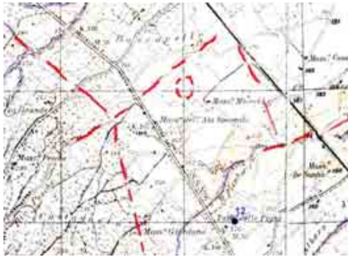
Fig. 5.5: stralcio della tavoletta topografica del foglio 161 III SO in cui è evidenziato il toponimo e la forma riferibile all'Aia Spaccata. In rosso sono riportate le faglie evidenziate dallo studio delle foto aeree.
