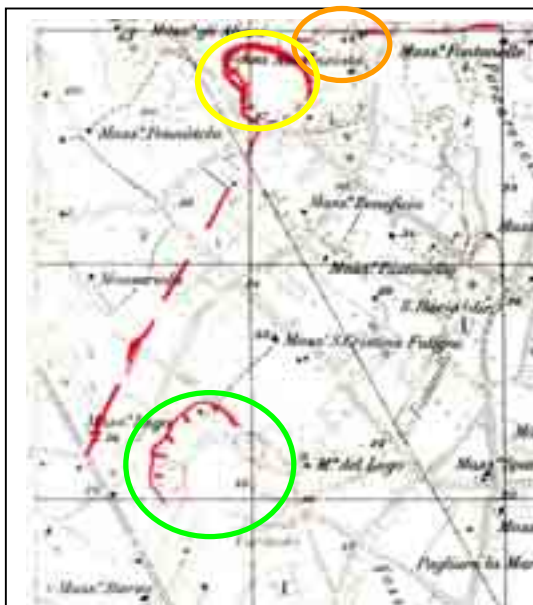
Fig. 5.10: Stralcio dalla tavoletta IGM 172 III NW con ubicazione del Lago di Falciano (in verde) della Fossa Annunziata (in arancio) e di La Valla (in giallo). In rosso si evidenzia la tettonica ricostruita dalle foto aeree del volo IGM del 1954.
