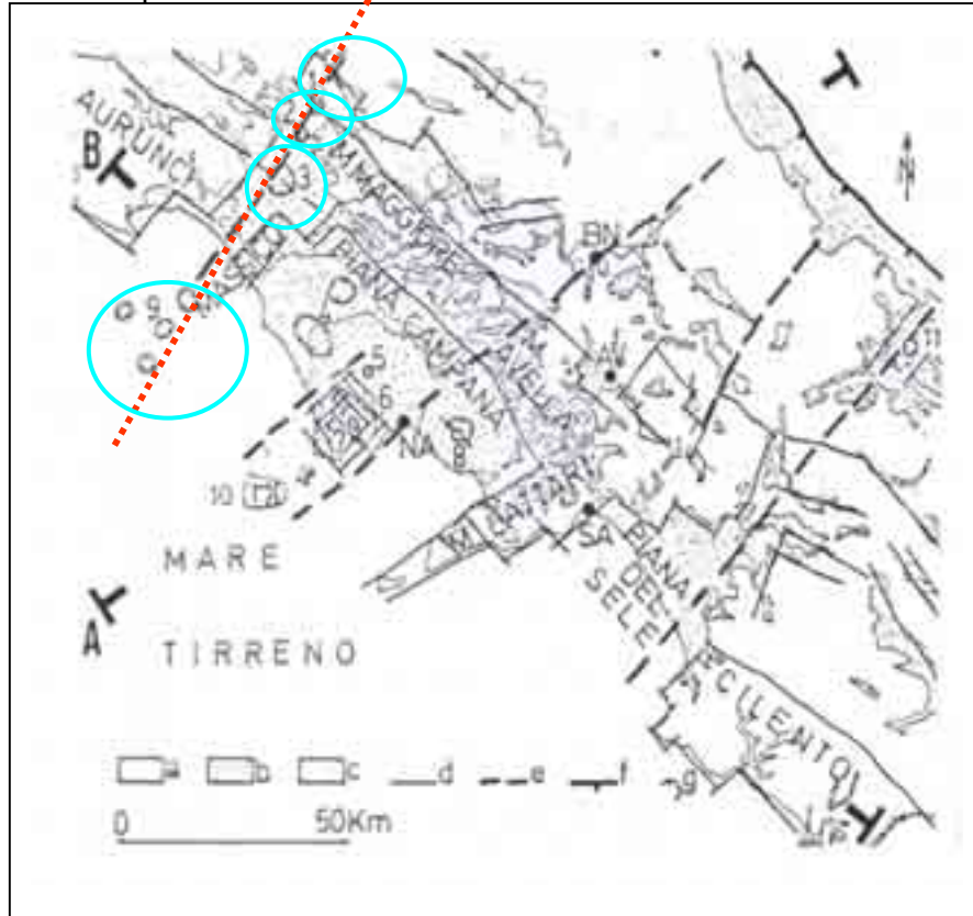
Fig. 3.2: Schema strutturale della Campania. (Ortolani e Pagliuca, 1988). Legenda: a: unità sedimentarie della catena appenninica; b: terreni vulcanici; c: terreni alluvionali; d: principali faglie superficiali quaternarie; e: principali faglie profonde quaternarie; f: margine esterno della catena; g: principali centri vulcanici quaternari. Con il numero 3 è indicato il vulcano di Roccamonfina. In rosso è evidenziata la linea Ortona-Roccamonfina. I cerchi indicano i centri eruttivi allineati lungo l'allineamento suddetto.
