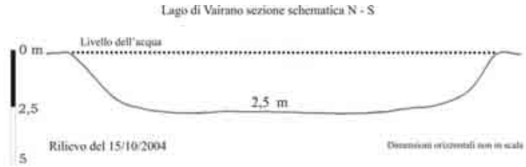
Fig. 5.9 bis: profilo batimetrico del lago di Vairano ricostruito mediante ecoscandaglio (dati APAT – Progetto Sinkhole).
