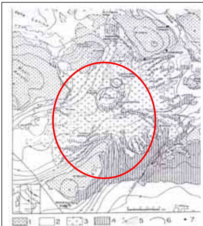
Fig. 3.5: Carta con le anomalie di Bouguer (da Frezzotti et alii , 1988). In rosso, l'area di nostro interesse. Legenda: 1: sedimenti calcarei e flyschoidi mesozoici; 2: depositi continentali e marini plioquaternari; 3: vulcaniti del Roccamonfina; 4: Ignimbrite campana; 5: Isoanomalie di Bouguer (in mgal); 6: bordi craterici; 7: centri periferici di emissione.
