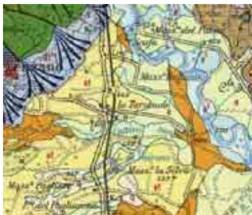
Fig. 5.9: Dettaglio della Carta Geologica in scala 1:100.000. LEGENDA: a : alluvioni e argille ; at: terreni umiferi e sabbie; q: limi e argille di colmata di depressioni bonificate; i: ignimbrite da trachitica a trachifonolitica ("tufo grigio campano" Auct.); dt 2 : detrito di falda sciolto o debolmente cementato; in verde, in alto a sinistra, i calcari cretaci
