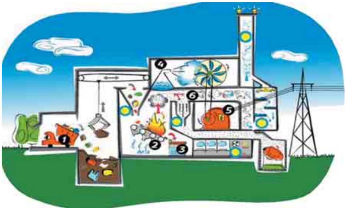
Figura 32. Schema di funzionamento di un impianto termovalorizzatore
