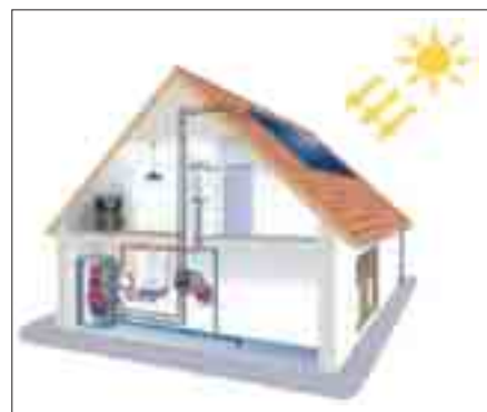
Figura 6. Impianto termosolare. Tutti gli edifici che dispongono di uno spazio soleggiato (tetto inclinato, tetto terrazato, giardino, ecc.) possono essere dotati di un impianto solare per la produzione di acqua calda sanitaria.
