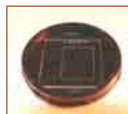
Figura 4.2. - Rivelatore montato all'interno del dosimetro
