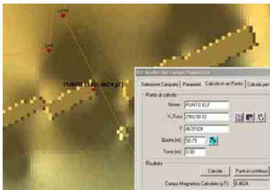
Fig.98 - Calcolo del Campo Magnetico del punto ELF con una corrente media di 200 A, sopra il palazzo in analisi, WinEDT.
