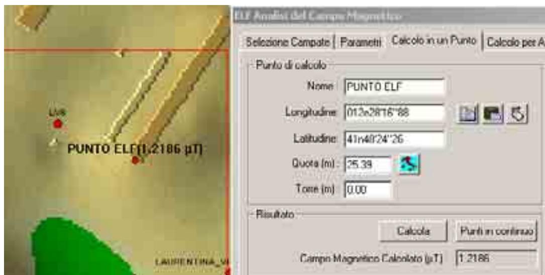
Fig.128 - Calcolo di un Punto ELF ad una corrente media di 400 (A), WinEDT.
