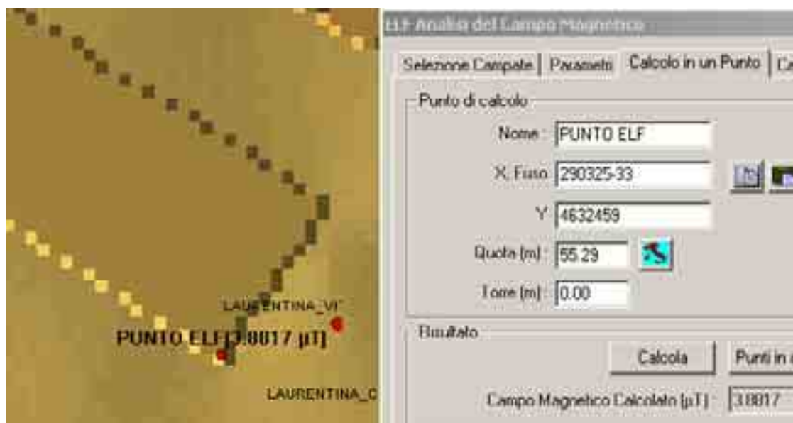
Fig.86 - Calcolo del Campo Magnetico in un punto ad una corrente media di 400 Ampere, WinEDT.
